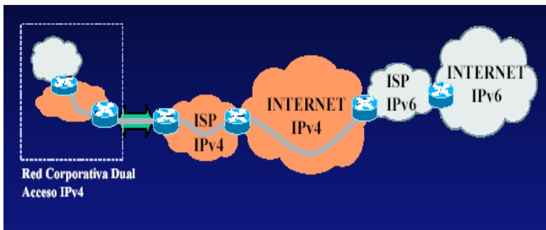
Figura 1.20 Ejemplo de migración de redes finales (clientes y servidores). A través de mecanismos de tipo túnel.
