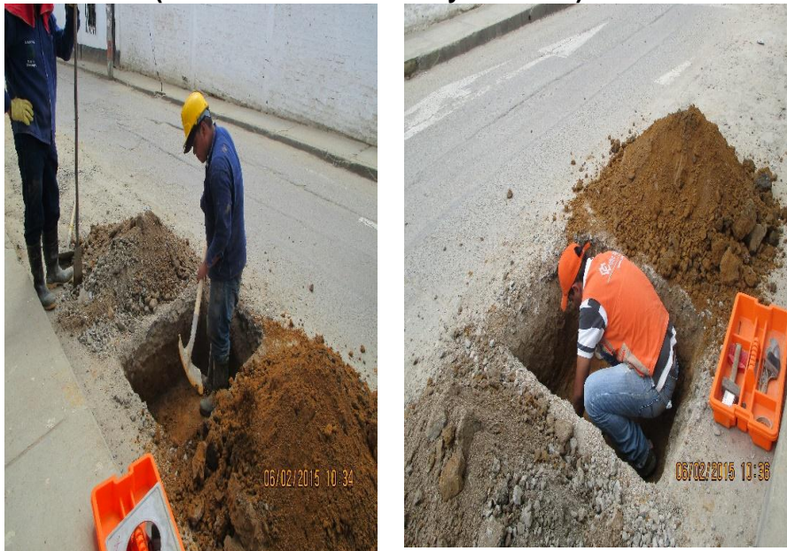
Figura 16. toma de muestras en sitio para calculo de densidades (carrera 9 entre calle 2 y 3 Centro)
