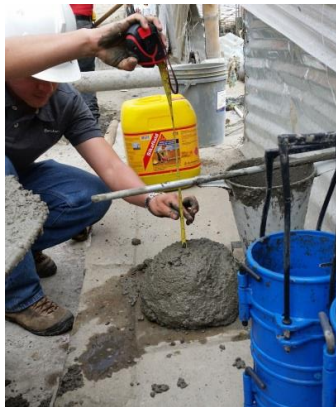
Figura No 7. ENSAYO DE SLUMP.
