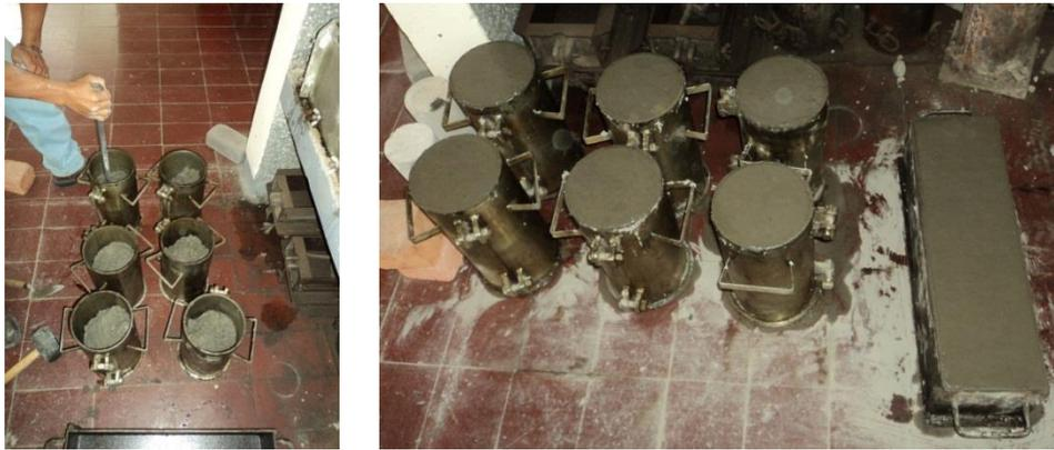
Figura 16. Toma de probetas de concreto
