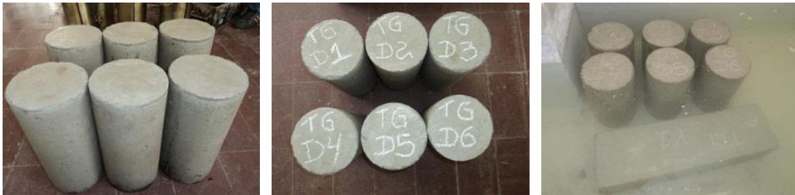
Figura 17. Extracción y curado de probetas de concreto
