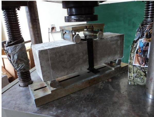
Figura 43. Montaje del dispositivo de medición de deflexión y sistema de apoyos.
