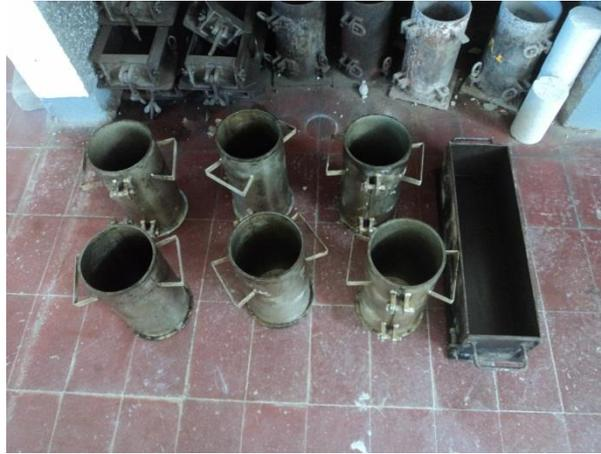
Figura 12. Preparación formaletas para mezcla de diseño con  $f'c = 26$  MPa
