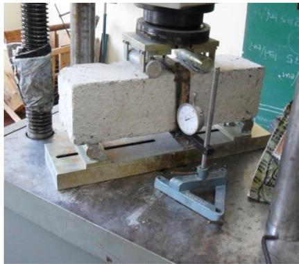
Figura 35. Montaje de dispositivo de medición de deformación de vigas de concreto.
