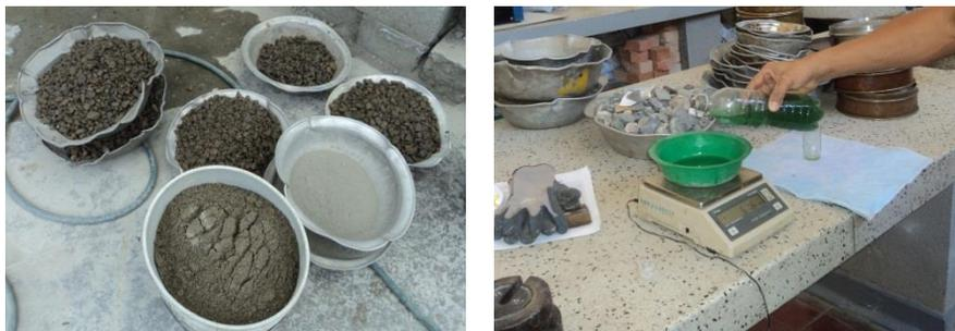
Figura 20. Pesaje de materiales para para mezcla No 1.
