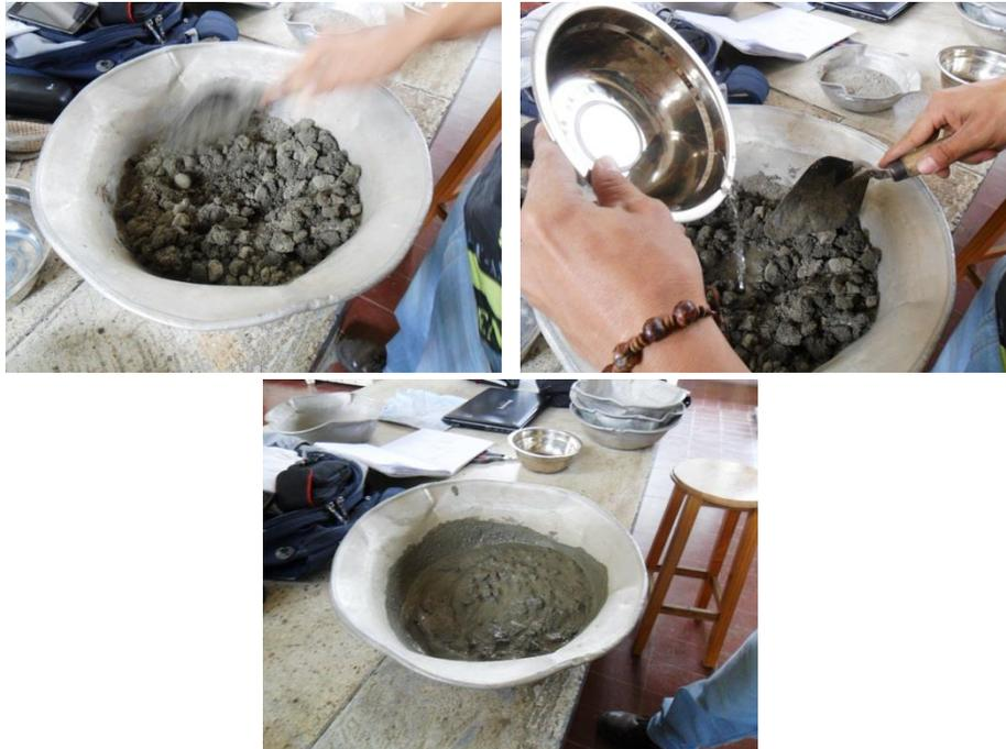
Figura 11. Mezcla de prueba de consistencia.
