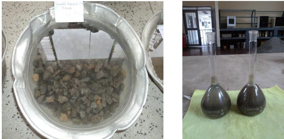
Figura 9. Gravedad específica y absorción de agregado grueso y fino
