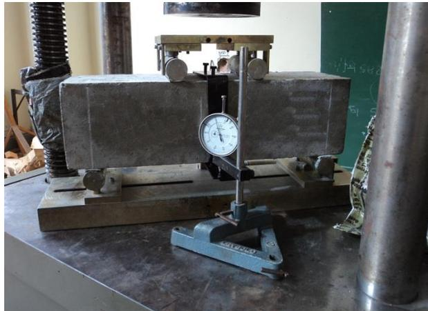
Figura 44. Montaje del deformímetro sobre el dispositivo de medición de deflexión.
