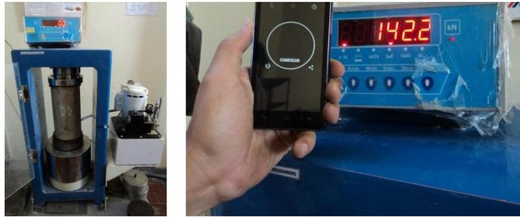
Figura 29. Calibración velocidad de carga prensa de compresión de cilindros de concreto.
