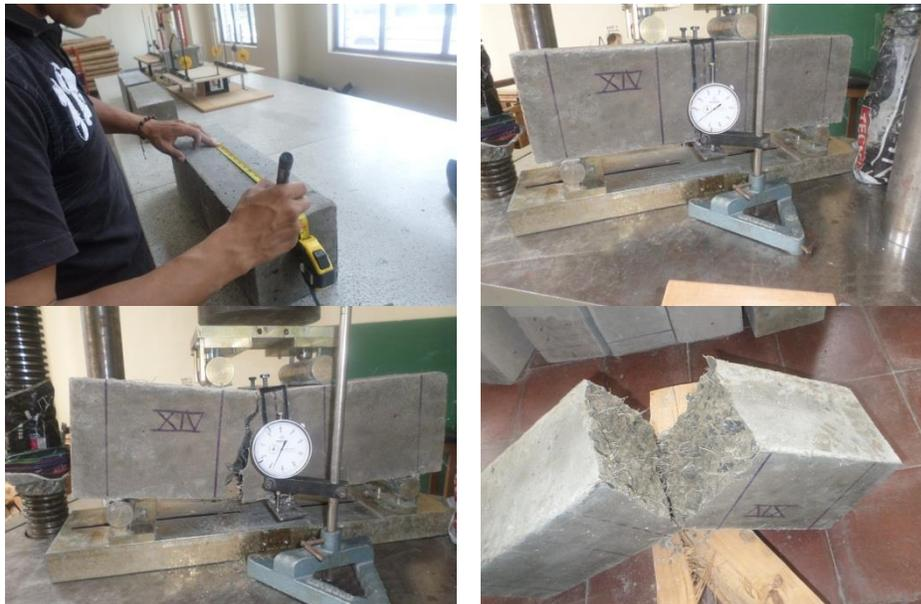
Figura 52. Marcación, montaje y ensayo de Probetas XIII, XIV y XV de la Mezcla No. 5.
