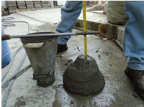
Figura 15. Asentamiento de mezcla de diseño de concreto  $f'_c = 26$  MPa
