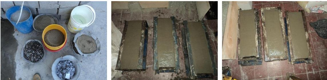
Figura 28. Mezcla y fabricación de probetas de concreto para mezcla No 5 y No. 6.
