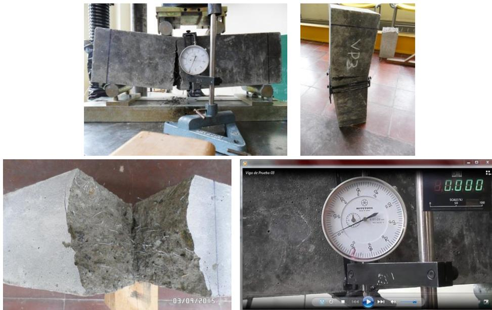
Figura 41. Ensayo de viga y video de adquisición de datos
