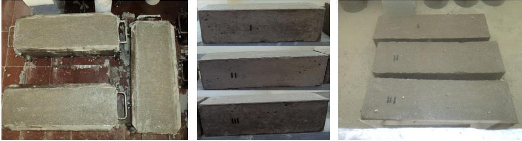
Figura 23. Extracción y curado de probetas de concreto para mezcla No 1.
