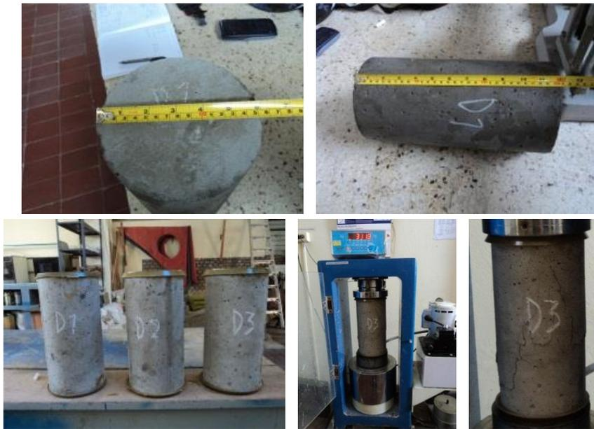
Figura 31. Medición y determinación de la resistencia a la compresión a 7 días.
