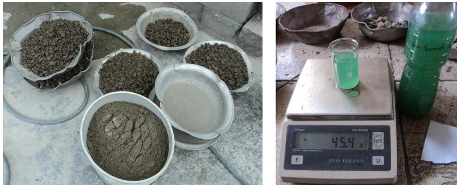
Figura 13. Pesaje de materiales para mezcla de diseño  $f'c = 26$  MPa
