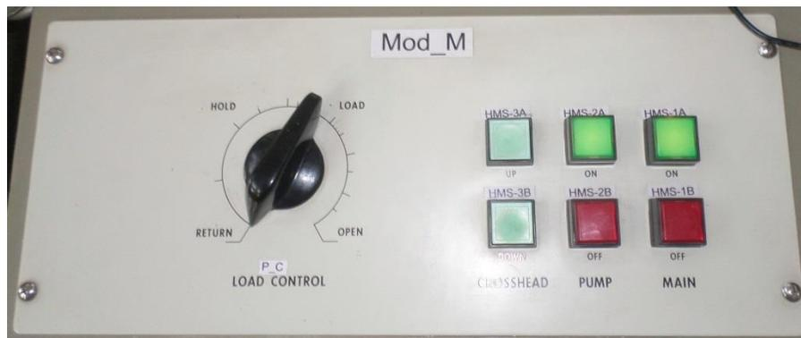
Figura 46. Tablero de controles de carga y movimiento de la máquina universal.
