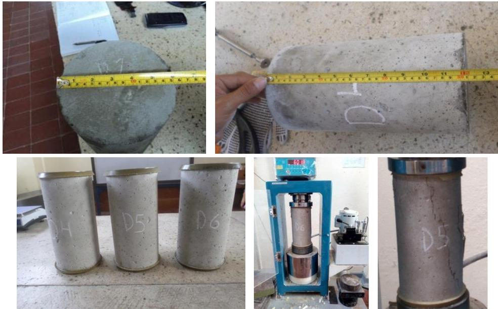
Figura 33. Medición y determinación de la resistencia a la compresión a 28 días
