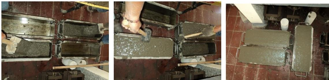
Figura 22. Toma de probetas de concreto para mezcla No 1.
