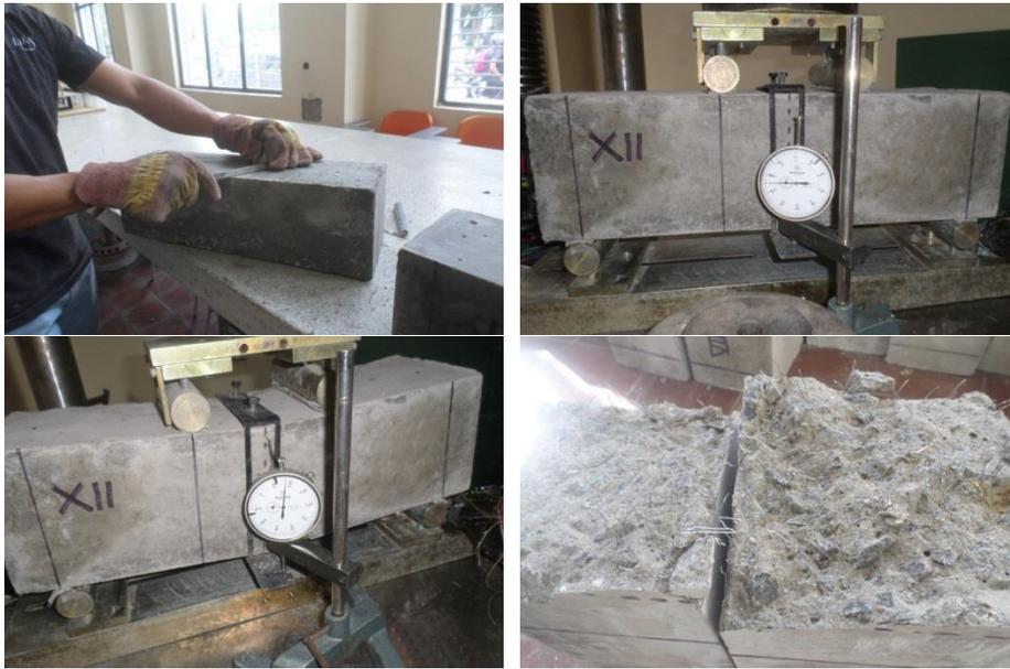
Figura 51. Marcación, montaje y ensayo de Probetas X, XI y XII de la Mezcla No. 4.
