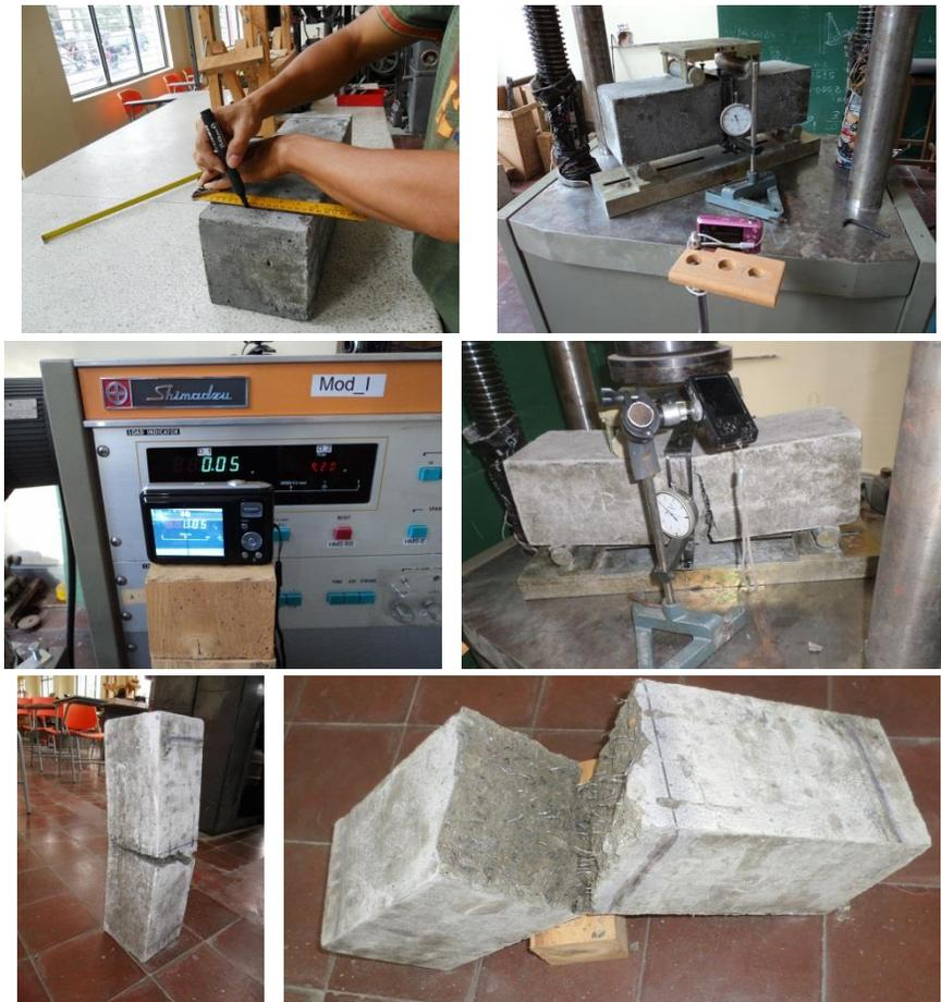
Figura 40. Marcación, montaje, ubicación de cámaras de video, adquisición de datos y ensayo de viga.
