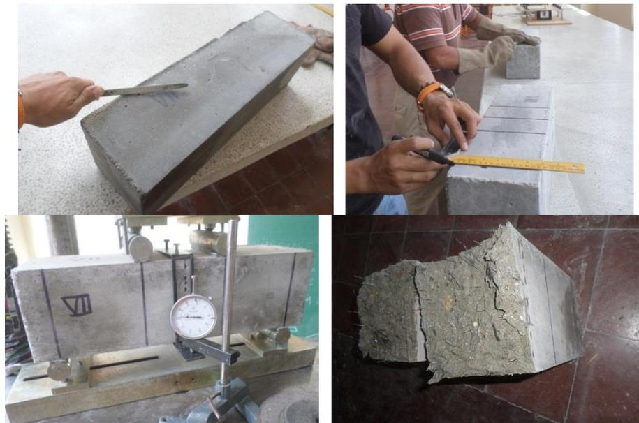
Figura 50. Marcación, montaje y ensayo de Probetas VII, VIII y IX de la Mezcla No. 3.
