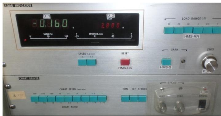
Figura 47. Indicador de carga y tablero de controles de la máquina universal.
