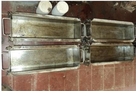
Figura 19. Preparación de formaletas para mezcla No 1.
