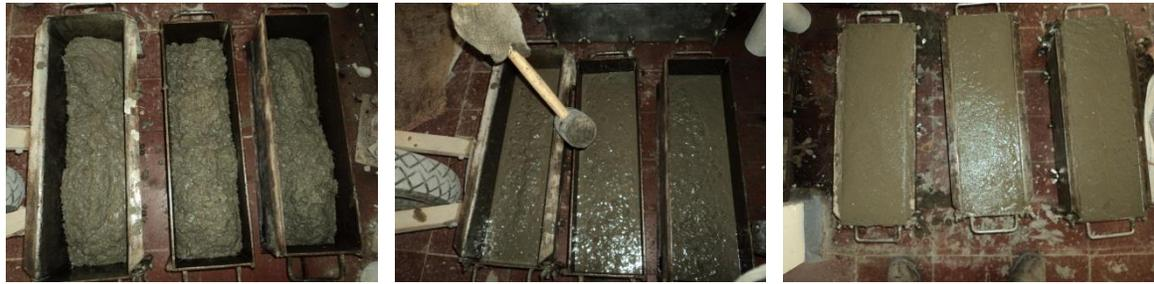
Figura 26. Toma de vigas de concreto para mezcla No 2, No. 3 y No. 4.
