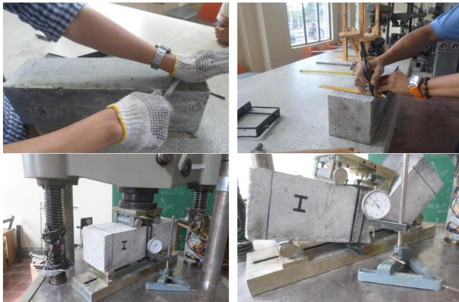
Figura 48. Marcación, montaje y ensayo de Probetas I, II y III de la Mezcla No. 1.
