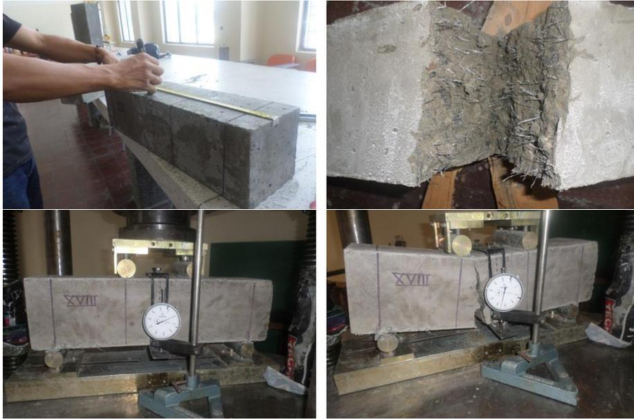
Figura 53. Marcación, montaje y ensayo de Probetas XVI, XVII y XVIII de la Mezcla No. 6.
