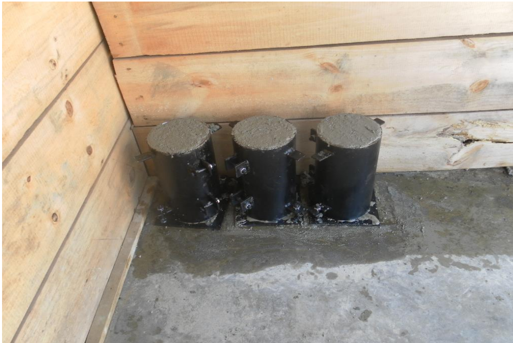
Figura 41.0 Cilindros tomados en obra para ensayo de resistencia a la compresión.
