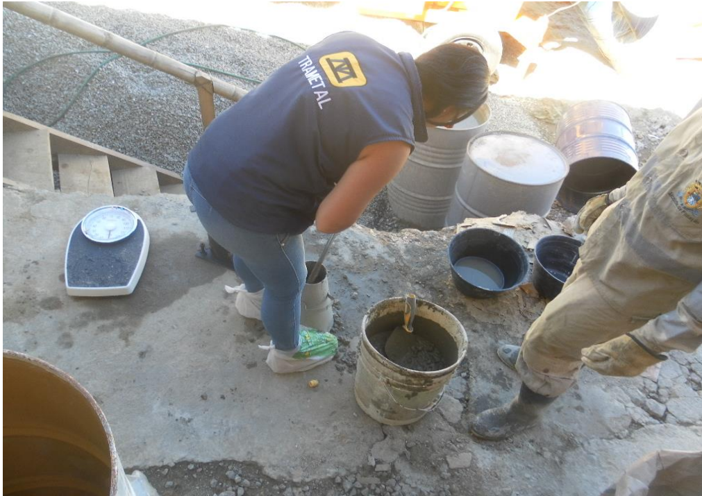
Figura 40.0 Ensayo de asentamiento empleando el cono de Abrahms.
