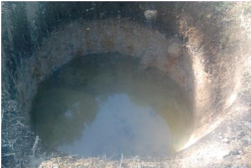
Figura 11. Cámara 220, nivel freático a baja profundidad
