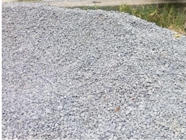
Figura 29. Triturado (grava) \frac{3}{4} " para fundición
