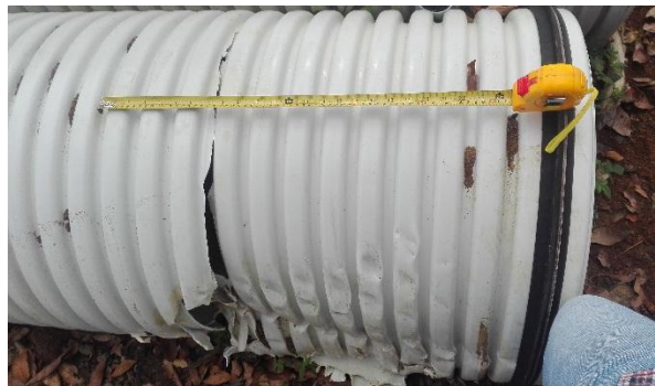
Figura 19. Tubo quebrado por mala manipulación.
