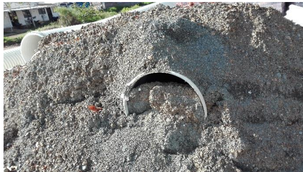
Figura 19. Tubo quebrado por mala manipulación.
