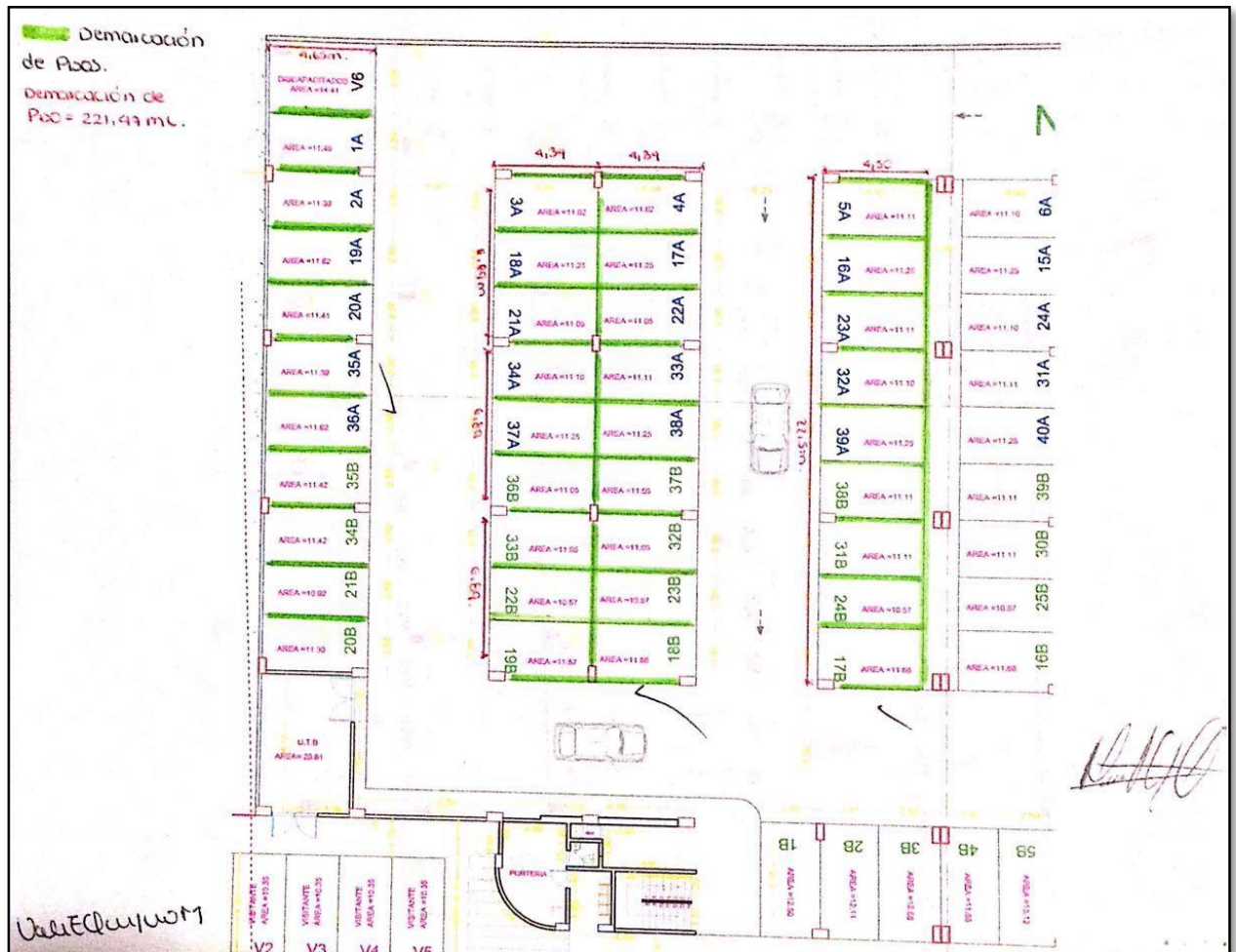
Fig. No. 36. Pre acta de Líneas de demarcación de pisos parqueadero sótano de torre A y B. Fuente propia
