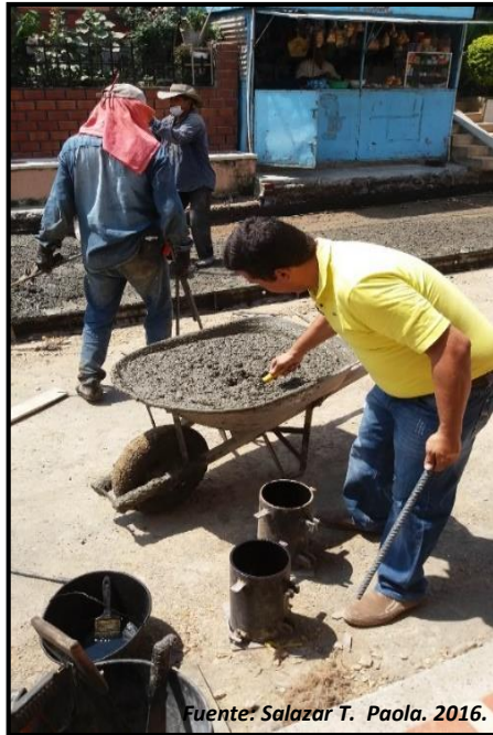
Ilustración 32. Toma de Muestras Cilindro para Resistencia del Concreto 3500 PSI
