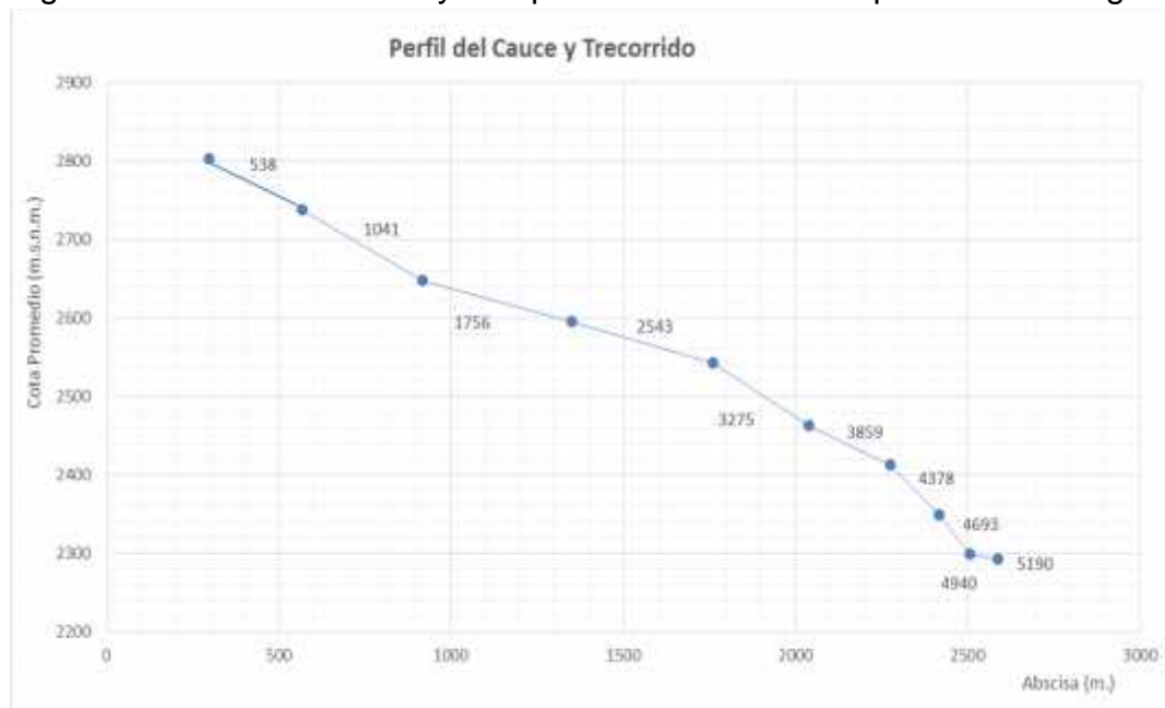
Figura F.3. Perfil del cauce y tiempo de recorrido de la quebrada Pichagua.
