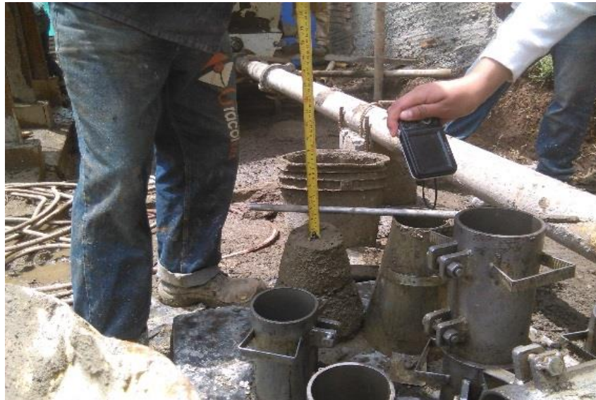
Figura N° 61: Prueba de asentamiento Slump.
