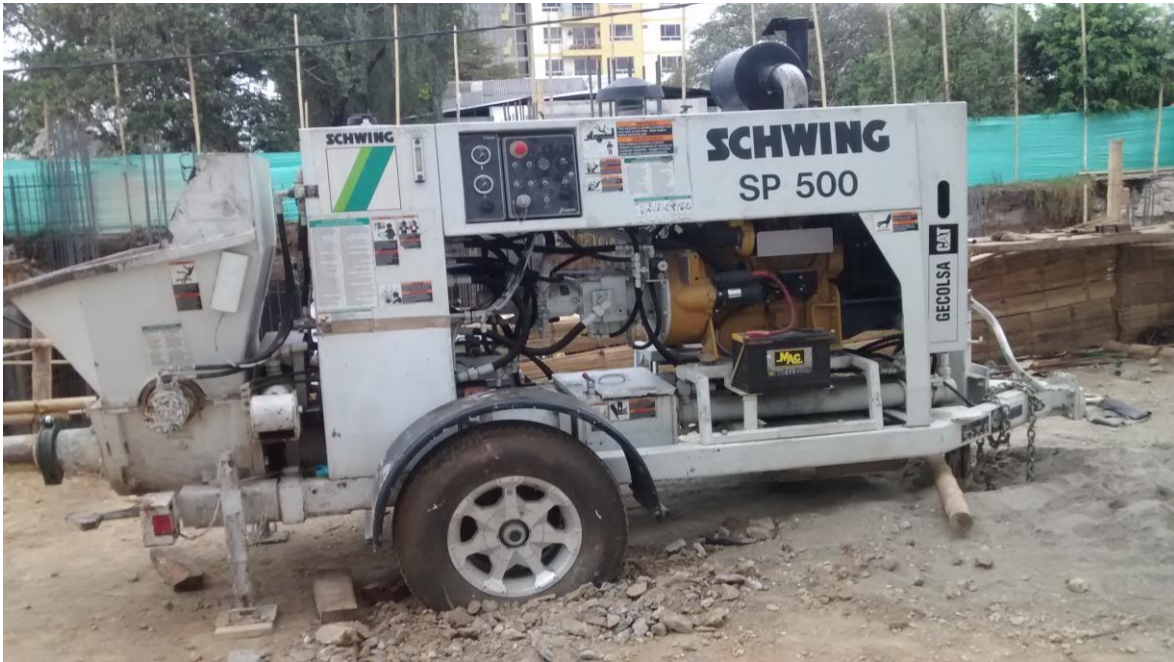
Imagen 41. Bombeadora de concreto usada en obra.
