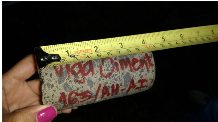
Figura 63. Núcleo de 10 cm para prueba de resistencia del concreto en una viga de cimentación. Fuente: Fotografía propia.
