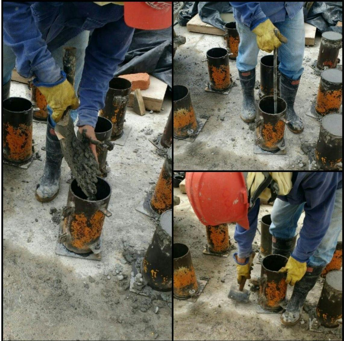
Figura 20. Toma de muestras de concreto para medir resistencia a la compresión.
