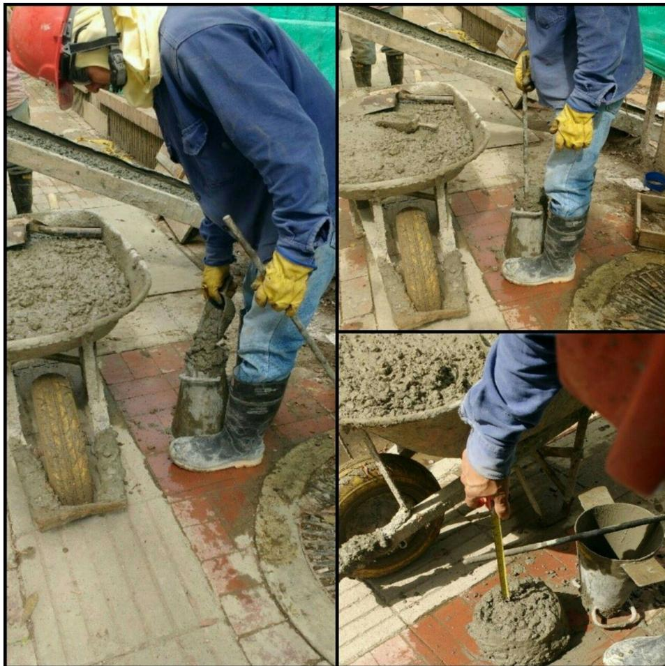
Figura 19. Prueba de asentamiento Slump. Fuente: Fotografía propia.
