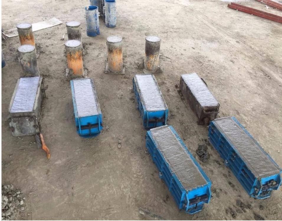
Figura 45. Muestras para resistencia del concreto. Fuente: Fotografía propia.
