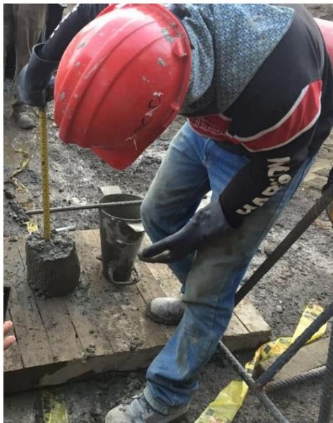
Figura 44. Ensayo de asentamiento Slump. Fuente: Fotografía propia.
