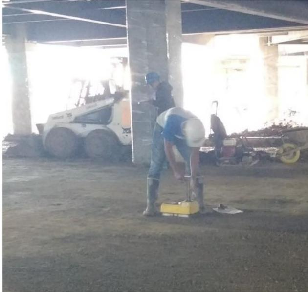
Figura 36. Ensayo de densidad y humedad con Densímetro Nuclear. Fuente: Fotografía propia.
