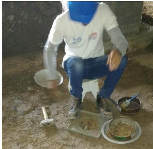
Figura 35. Ensayo de densidad y humedad Método cono de arena. Fuente: Fotografía propia.
