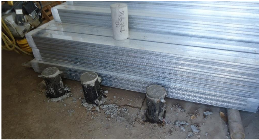
Figura 8. Cilindros de concreto para ensayo a compresión.
