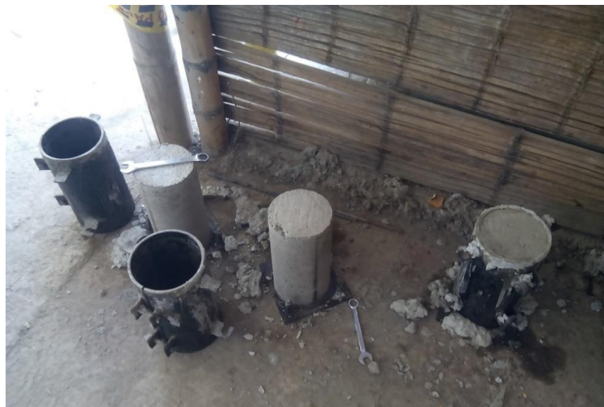
Figura 9. Desencofrado de cilindros de concreto para ensayo a compresión.
