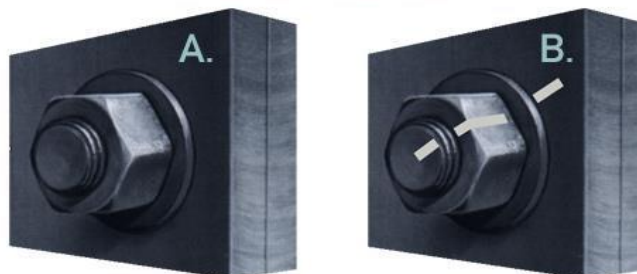
Figura 43. Marca para ajuste a 2/3 de giro.
