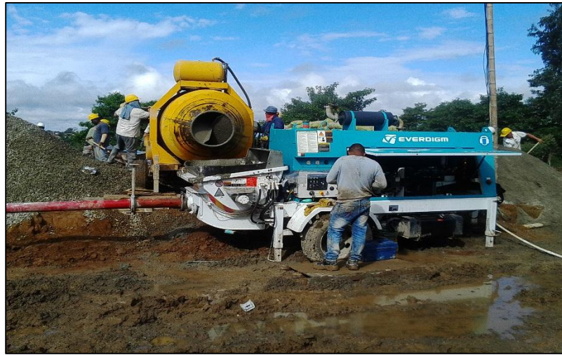
Figura No.30 Mezcladora Semco con una capacidad de 18 pies 3 y bomba de concreto.
