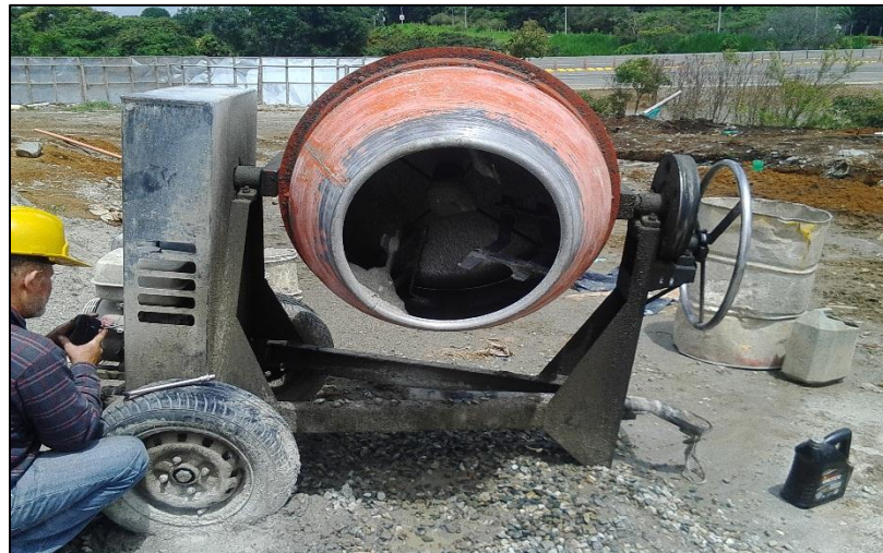
Figura No.31 Mezcladora con una capacidad de 6 pies 3 .
