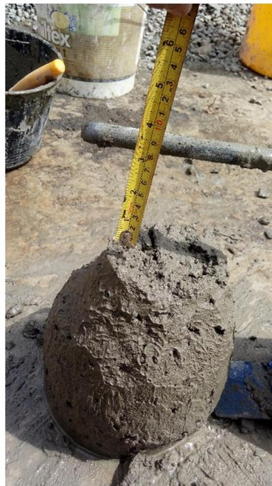
**Foto 16: Prueba de Slump**
