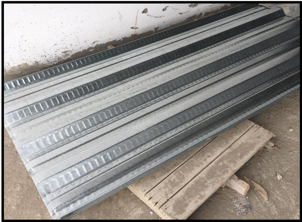
Figura 51. Teja corpalosa usada en la losa de entrepiso Fuente: Propia
