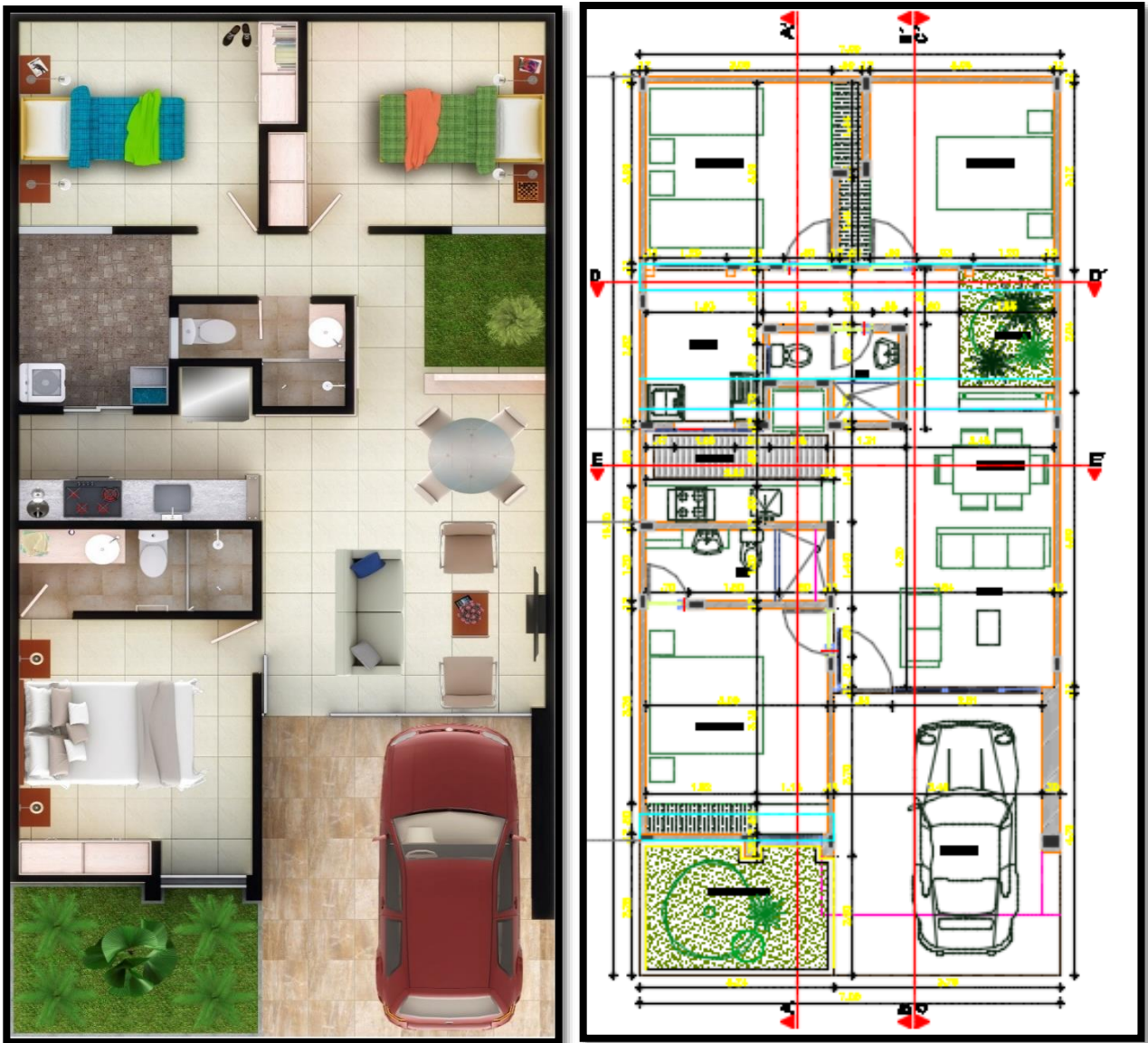
Figuras 8 y 9. Modelación y plano arquitectónico casa de un piso Fuente: Archivo de Administración Construimos del Huila
