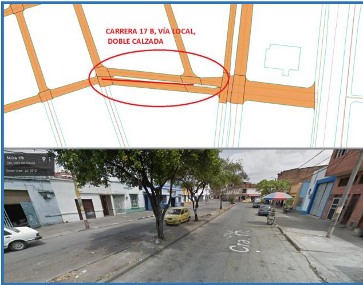
Figura 14 Vía Local, doble calzada. Inicialmente se esperaba que todas las vías locales tuvieran única calzada, en el proceso de segmentación se encontró que algunas vías con dicha jerarquía tienen dos calzadas. No se ha encontrado ningún caso en que una vía local tenga más de dos calzadas.
