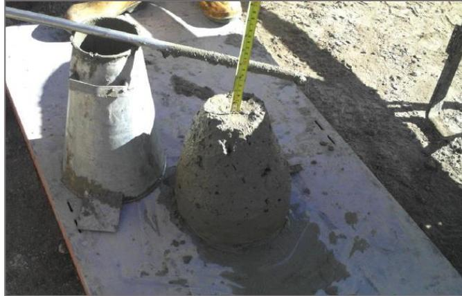
**Figura 27:** Cono de Abrams para ensayo de consistencia (slump)
