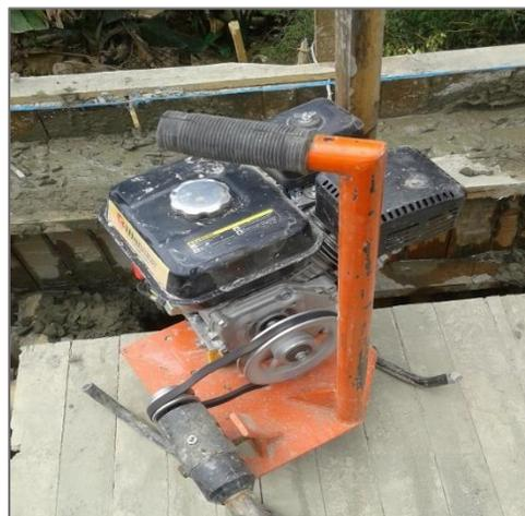
**Figura 48:** Equipo para vibración
