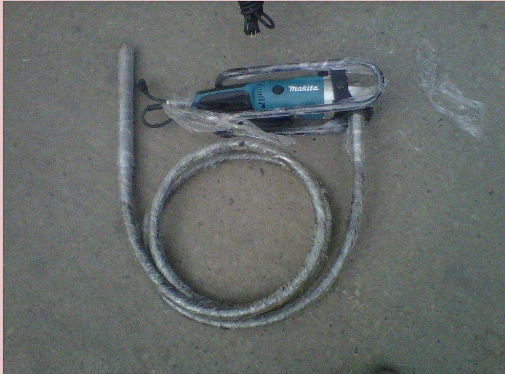
*Figura 28: Vibrador que se utiliza en fundición. Fuente: Google imágenes.*
