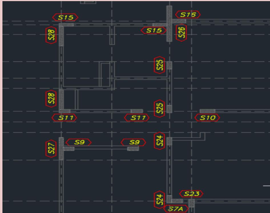
Figura 15: Elementos de borde. Fuente: Planos estructurales de Torre II.
