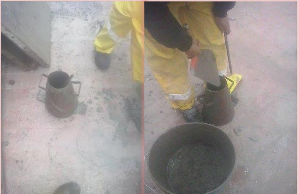
*Figura 31: Prueba de slump o de cono. Fuente: Elaboración propia*
