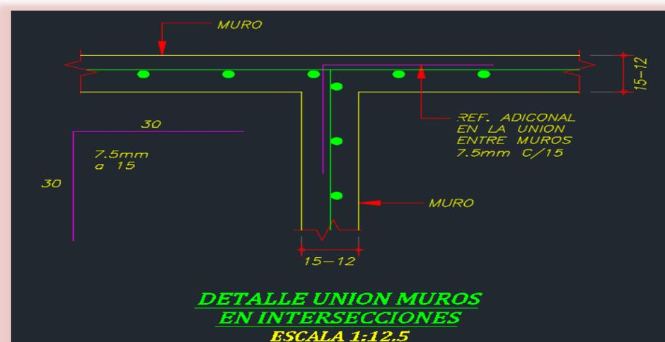
Figura 14: Intersección de los muros estructurales. Fuente: Elaboración propia
