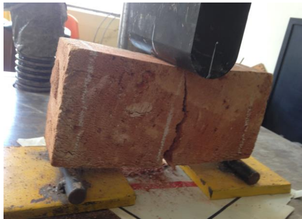
Figura 31. Falla del ladrillo con carga posición 1
