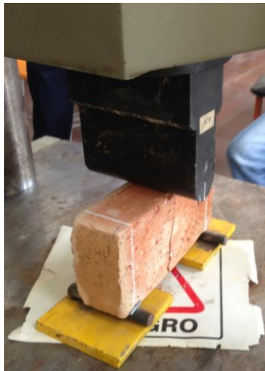
Figura 30. Ensayo a tracción del ladrillo posición 1
