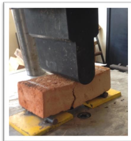
Figura 34. Falla del ladrillo con carga posición 2
