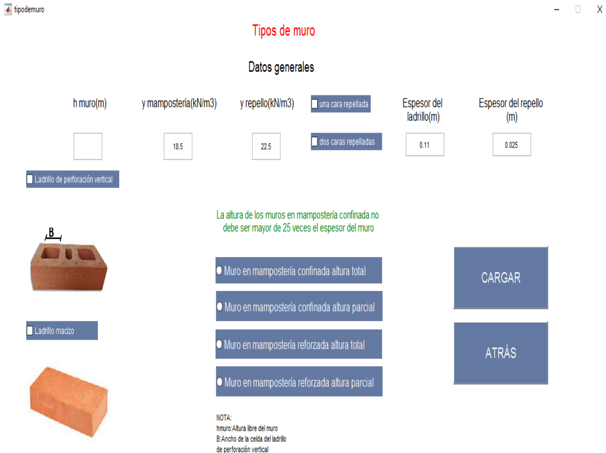
Figura 40. Interfaz tipo de muro
