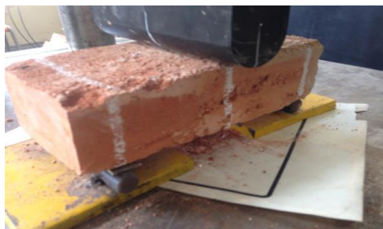
Figura 33. Ensayo a tracción del ladrillo posición 2
