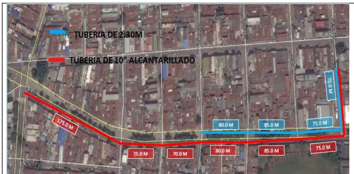
Imagen 14. Planeación de tubería de 2.3m y tubería 10” alcantarillado
