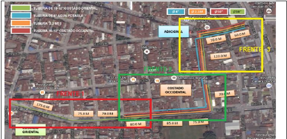
Imagen 1. Referencia de los frentes 1, 2 y 3 del colector San Bosco.
