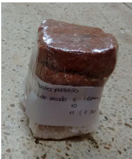
Figura 36: Empacado de la muestra después del ciclo de secado.
