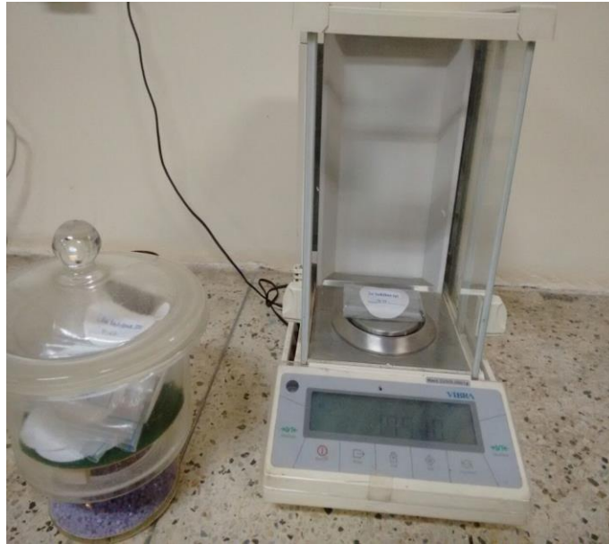
Figura 42: Determinación del peso de papeles filtro húmedos
