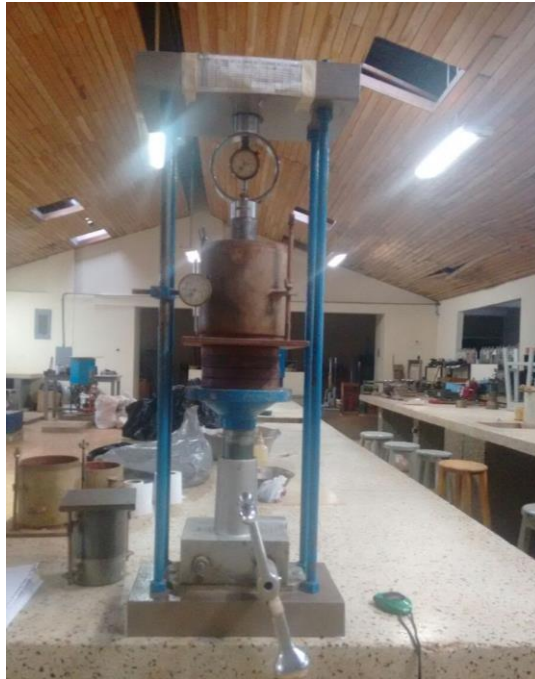
Figura 31: Montaje para ensayos CBR
