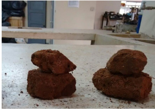
Figura 34: Muestras talladas para ensayo de succión mátrica - Ingeniería civil
