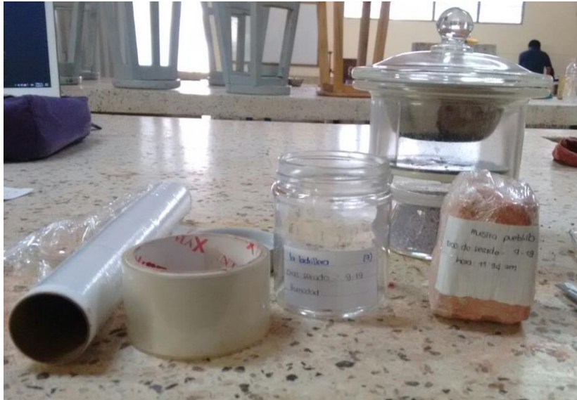
Figura 39: Materiales para ensayo de succión
