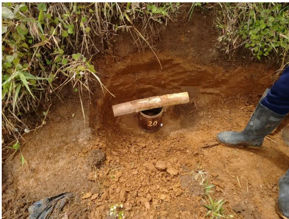
Figura 26: CBR inalterado- Ingeniería civil
