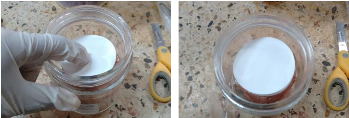
Figura 40: Colocación del papel filtro en la muestra
