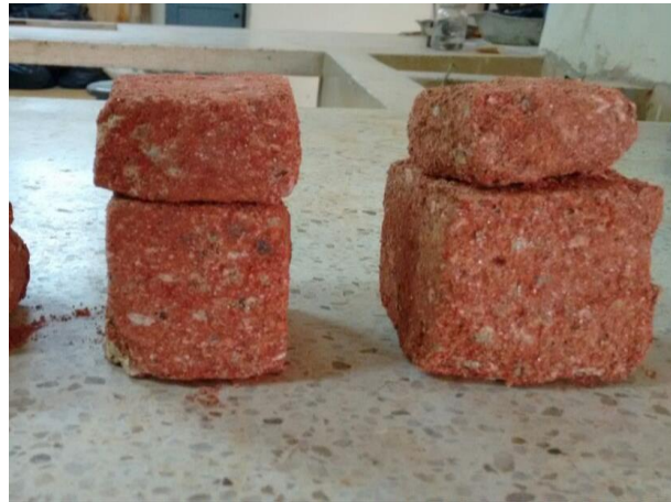
Figura 35: Muestras talladas para ensayo de succión mátrica- La ladrillera
