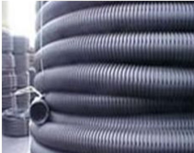
Figura 26. Tubería para filtro.
