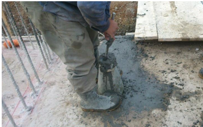
Figura 57. Apisonado del concreto para el ensayo de asentamiento con el cono
