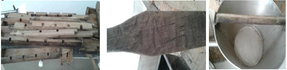
Figura 6. Elementos elaborados en material inadecuado y con grietas
