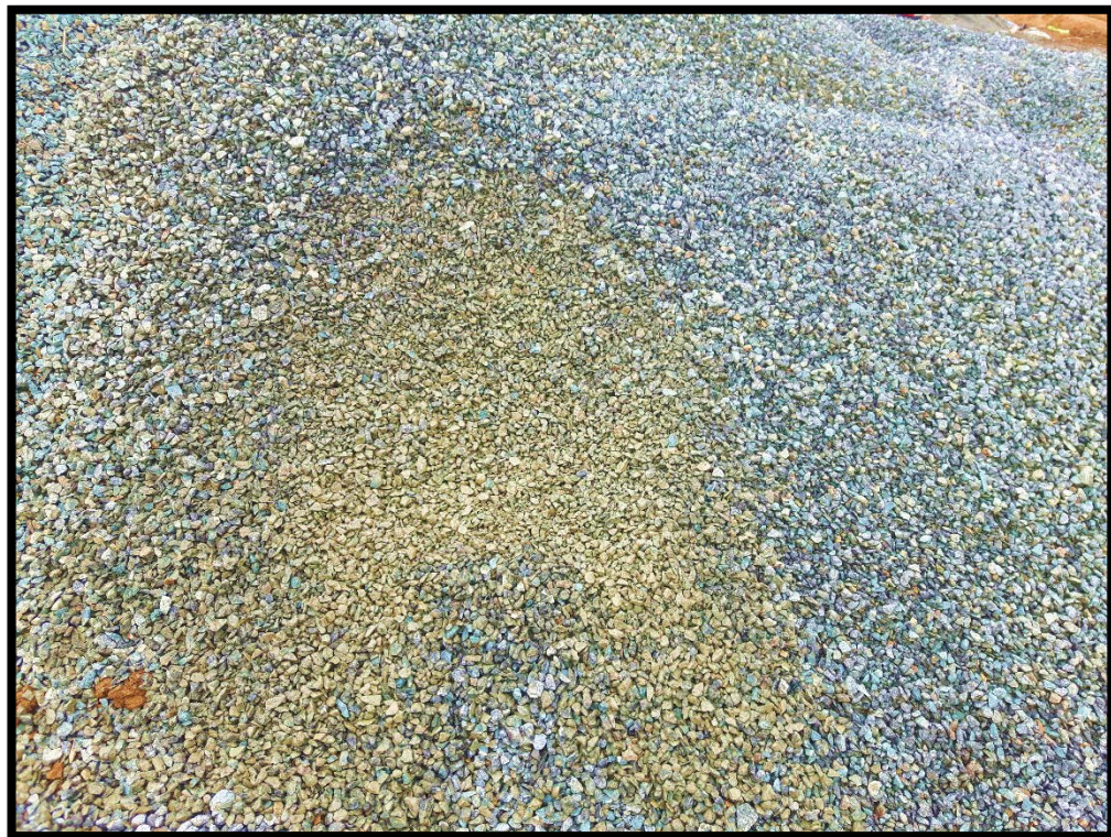
Ilustración 12. Contaminación en el agregado 3/8"
