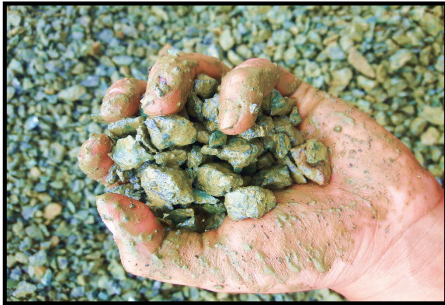
Ilustración 13. Contaminación en el agregado 3/8"
