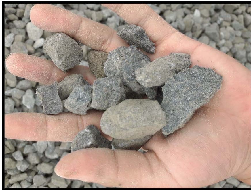
Ilustración 11. Contaminación en el agregado 3/4"
