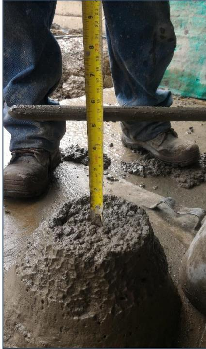
Figura N° 7 Determinación de asentamiento. Fuente propia
