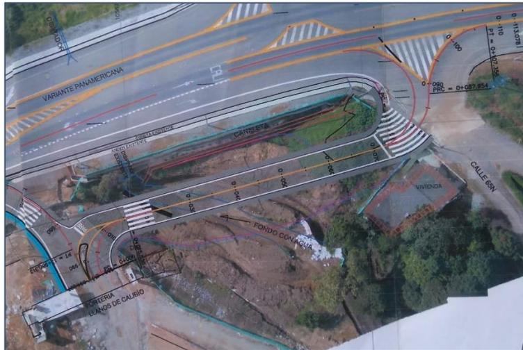
Figura N° 23 Diseño vía proyectada sobre box coulvert. Fuente propia
