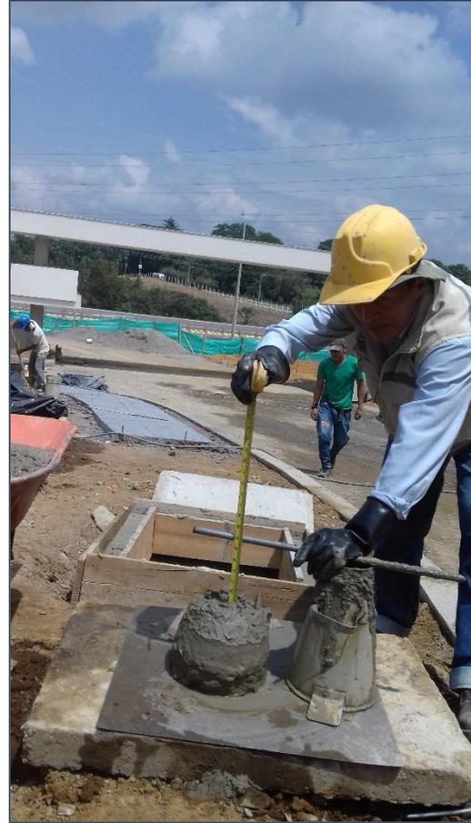
Figura N° 46 Asentamiento del concreto. Fuente propia
