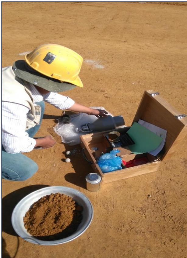
Figura N° 36 Determinación de humedad. Fuente propia
