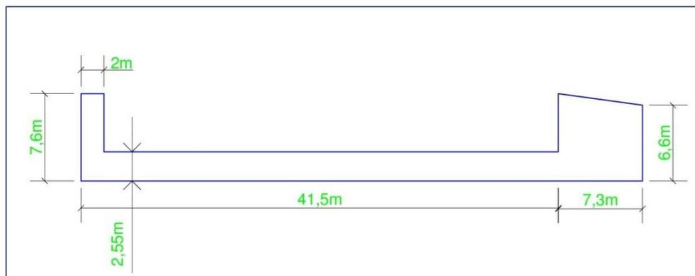
Figura N° 5 Vista en perfil del box coulvert. Fuente propia
