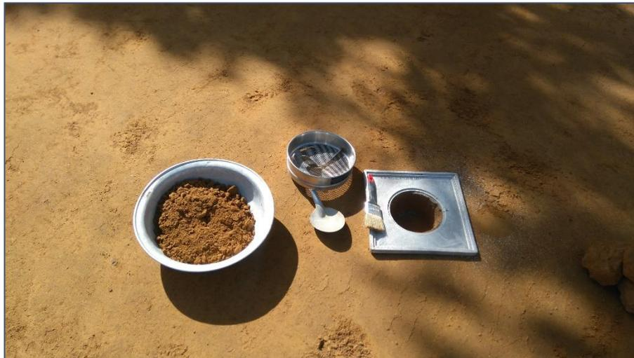
Figura Nº 34 Extracción de suelo, ensayo cono de arena. Fuente propia
