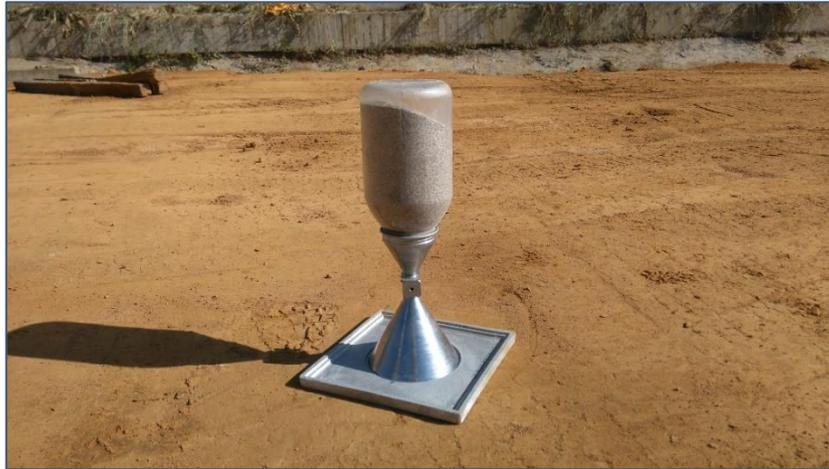
Figura N° 35 Llenado de hueco con arena ensayo cono de arena. Fuente propia
