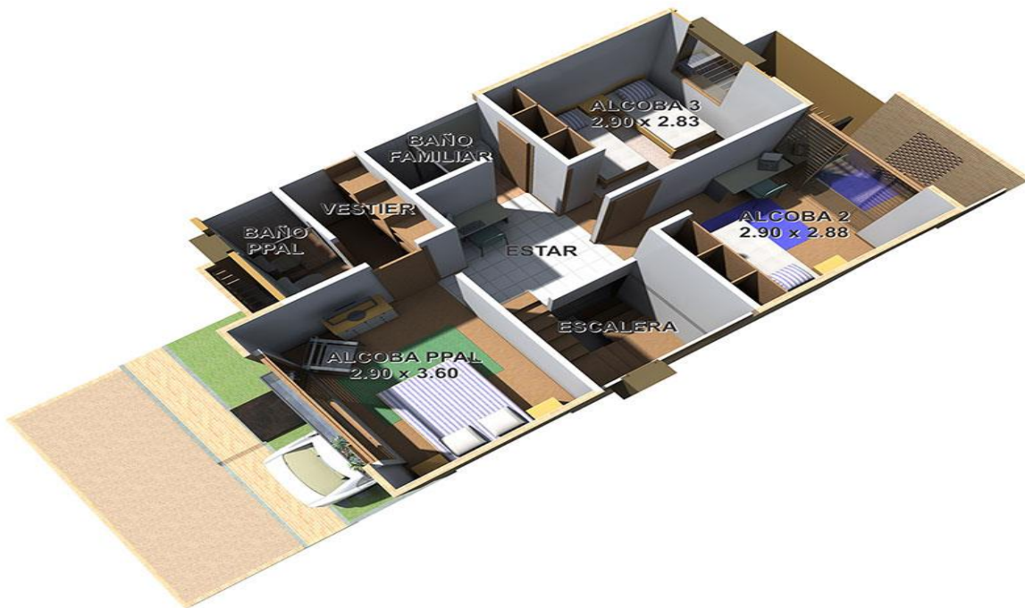
Figura 5. Plano segundo piso. Fuente: Procal Constructores.
