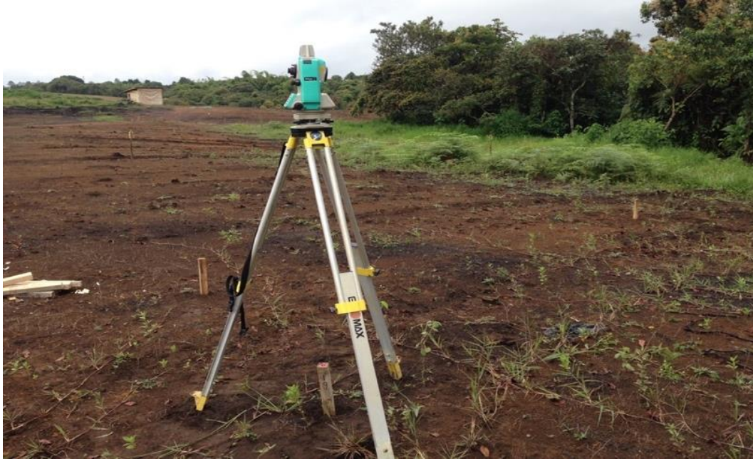
Figura 26. Toma de topografía para cálculo de volúmenes. Fuente: Elaboración propia.
