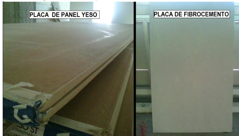
Figura 7. Placas para muros en estructura liviana
