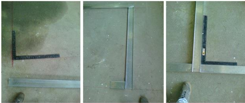
Figura 50. Procedimiento de verificación con escuadras
