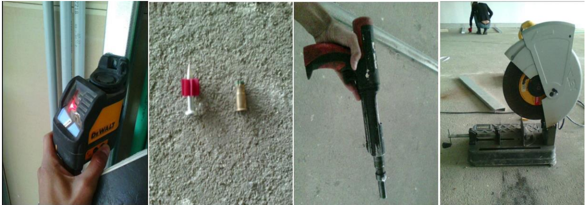
Figura 15. Herramientas para replanteo. De izquierda a derecha. Nivel laser. Perno 1/2" y cartucho. Pistola de anclaje. Maquina cortadora de estructura Stanley 14" tipo 1
