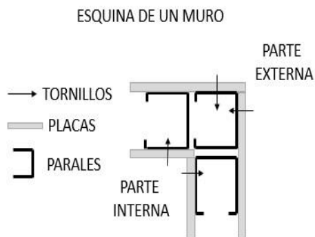
Figura 18. Estructura en esquina y marcos de puertas de muros
