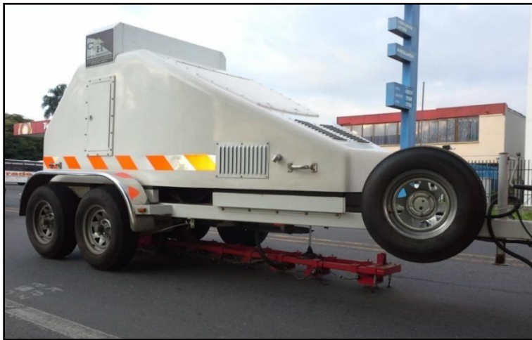
Fotografía 1 Equipo Deflectómetro de Impacto HWD JILS 20. Fuente: CYH INGENIERIA Y CONSTRUCCIÓN S.A.S
