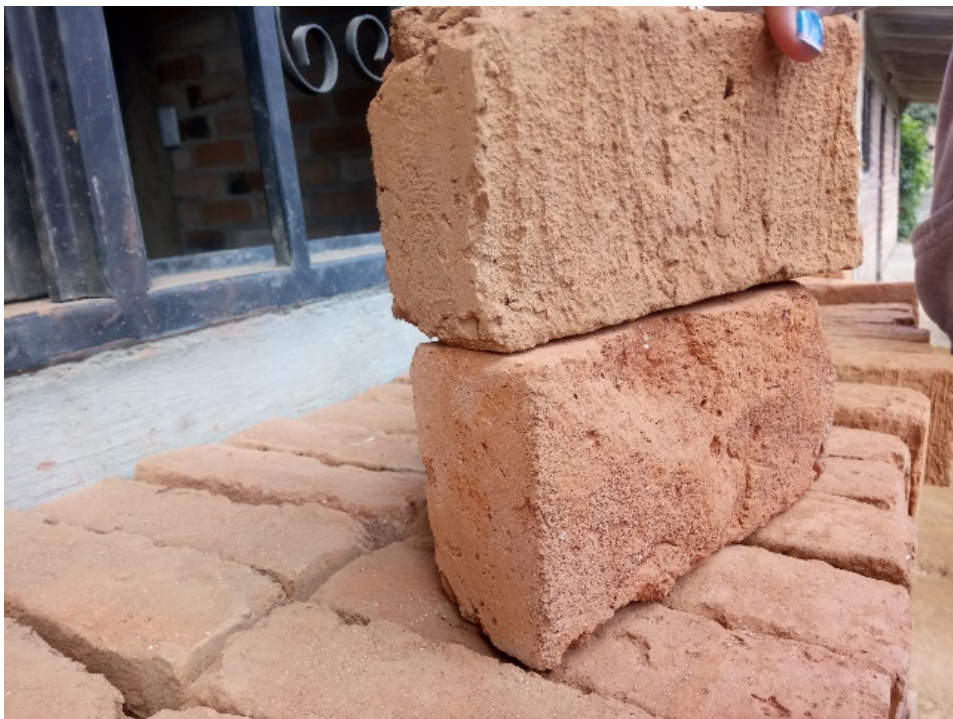
Fig 7: Ladrillo de mala calidad
