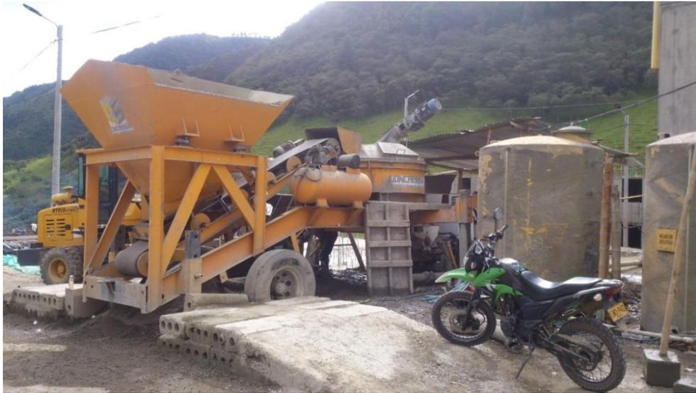
Figura No. 21 Planta de concreto de 1m3 (Fuente: Propia)
