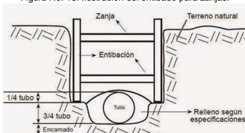
Figura No. 13. Ilustración del entibado para zanjas.
