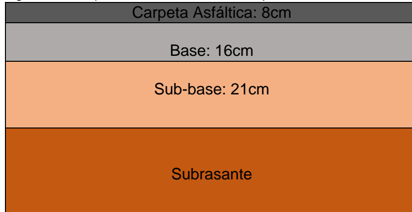
Figura 23. Esquema de la estructura de pavimento flexible.
