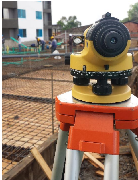
Fotografía 61. Nivel de precisión sobre trípode. Fuente: Tomada por el pasante
