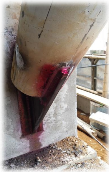
Fotografía 33: Aplicación tinta penetrante.
