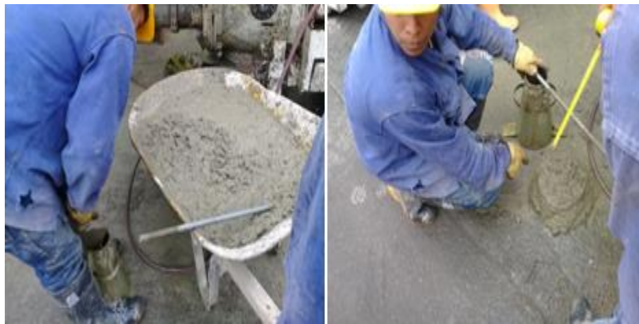
Figura 18: Ensayo de asentamiento con el cono o "slump". (Fuente: Autor).
