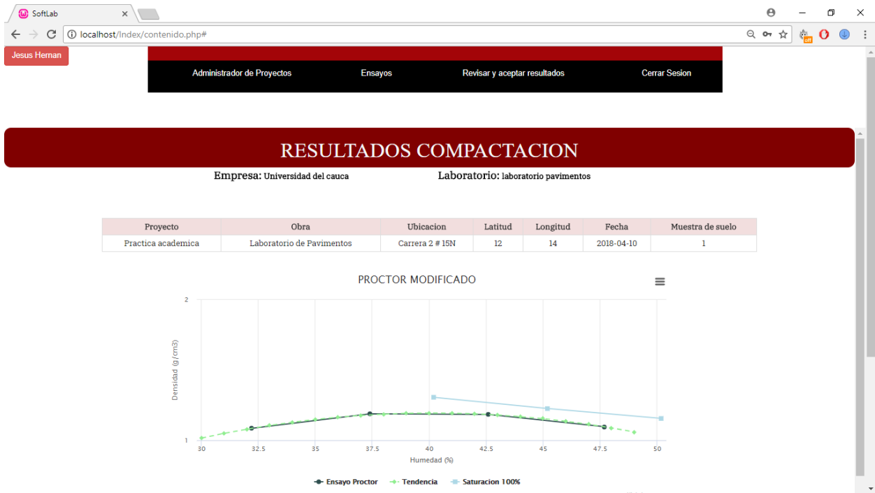
Figura 56: frontend, Vista del ensayo de Compactación almacenado en la plataforma, SoflLab. (Google Chrome Versión 64.0.3282.167)
