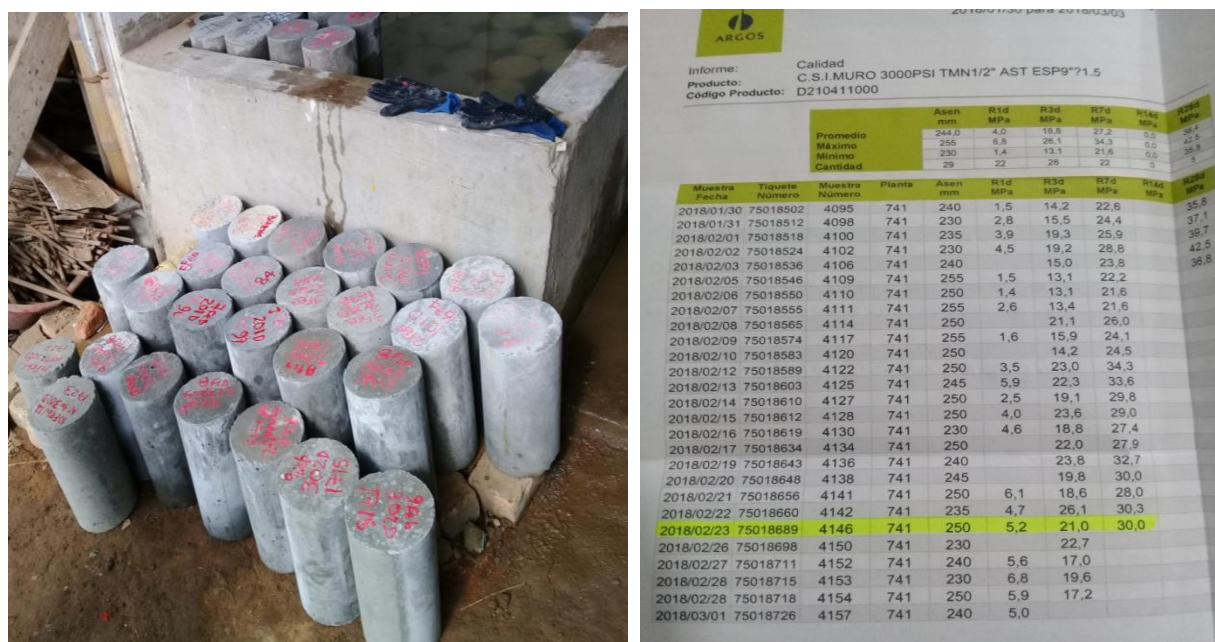
Fotografía 20: Muestras seleccionadas para ensayo de resistencia y resultados. Fuente: autor.
