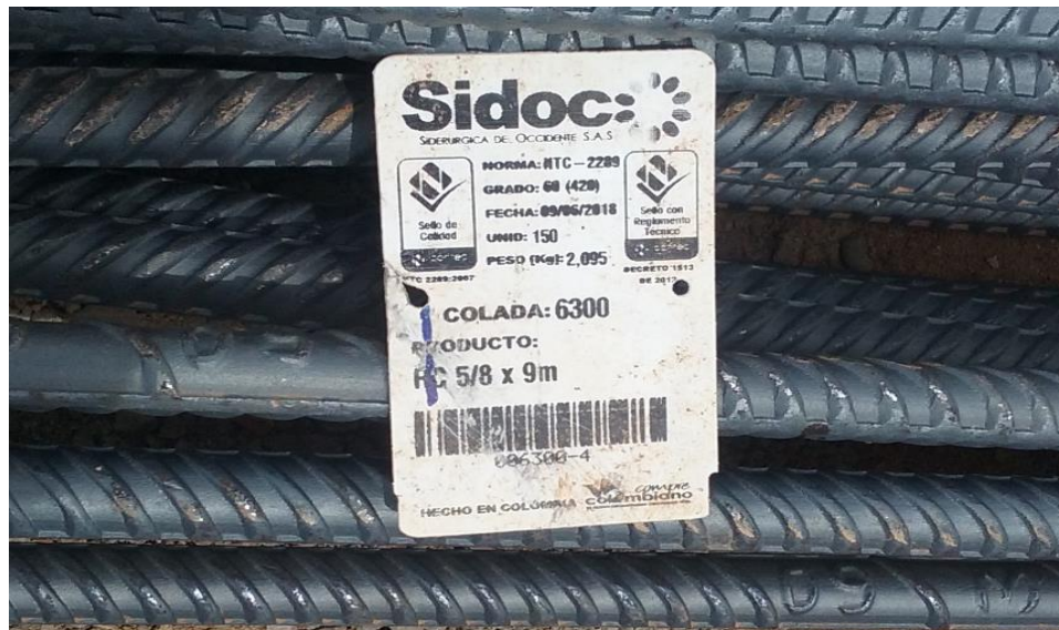
Figura 6.38 Compra de varillas de acero corrugadas
