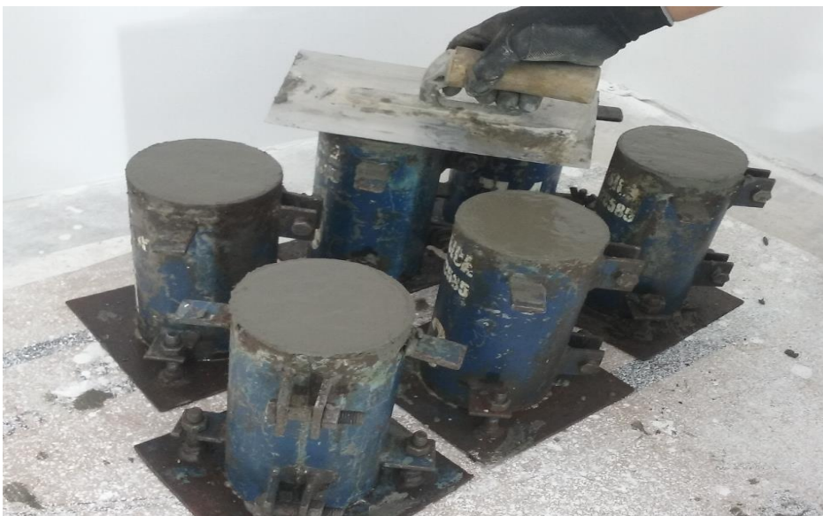
Figura 6.7 Toma de muestras de concreto
