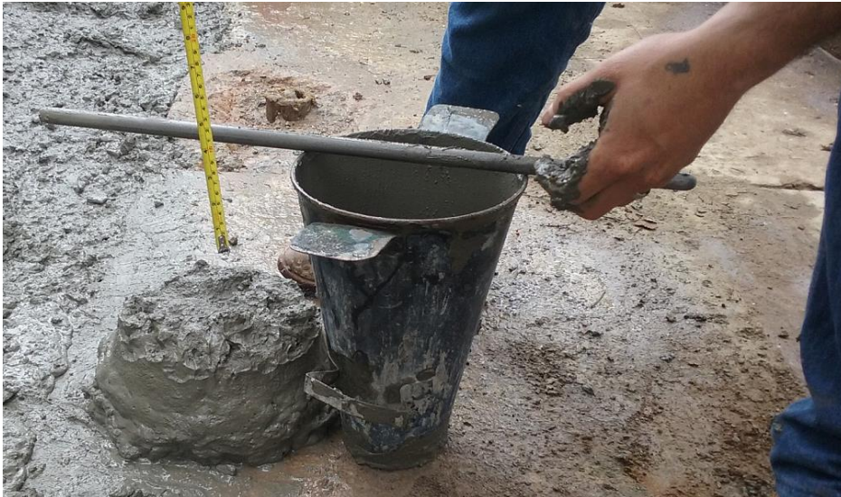
Figura 6.6 Ensayo de Asentamiento SLUMP
