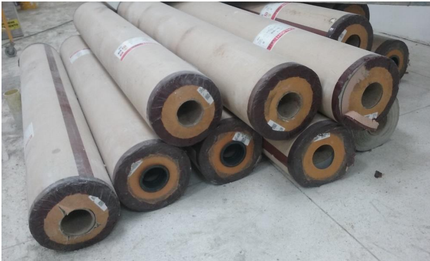
Figura 6.46 Rollos de piso en vinilo PVC de 2m de ancho x 20m de largo
