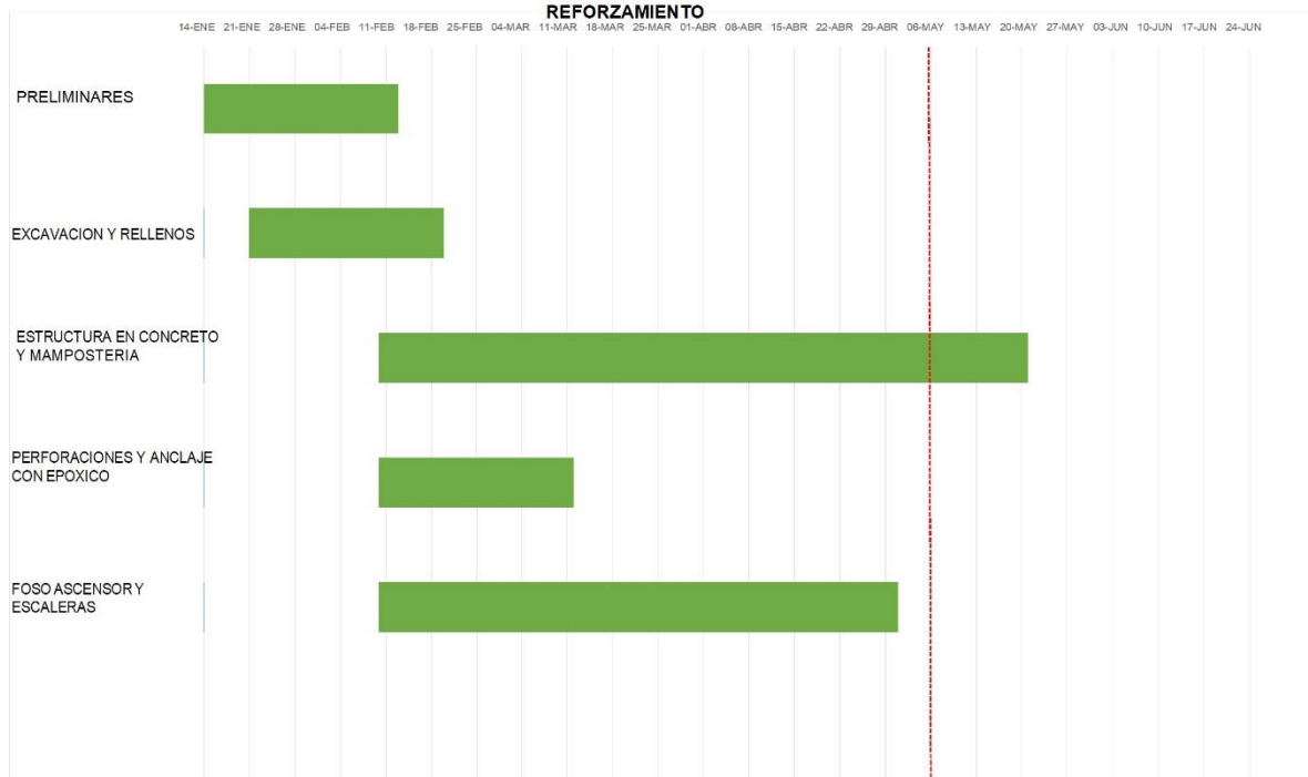
Figura 6.3 Cronograma de obra (Reforzamiento estructural)
