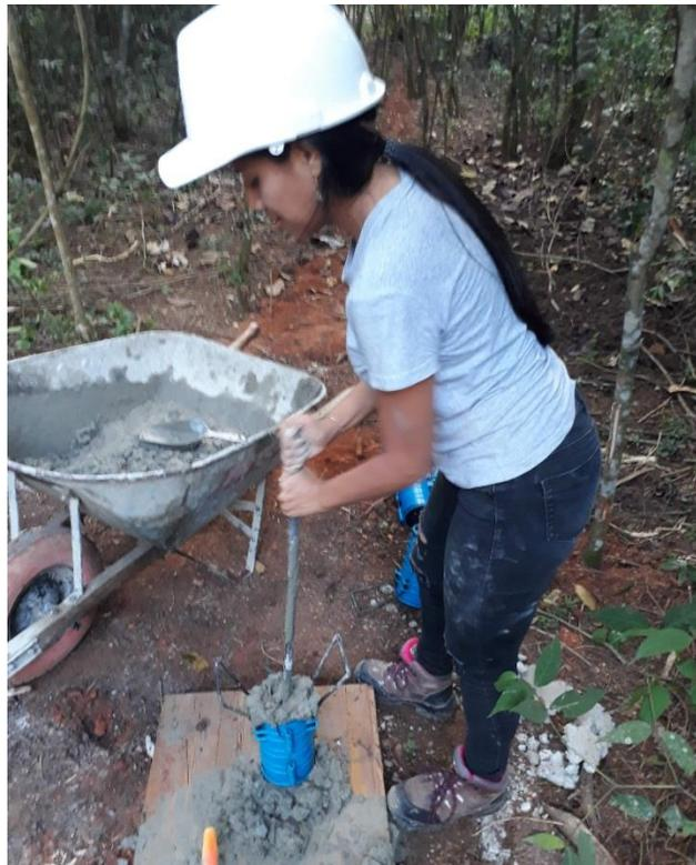
*Imagen 35. Toma de cilindros para zapata 2 de viaducto Corpopaló.
