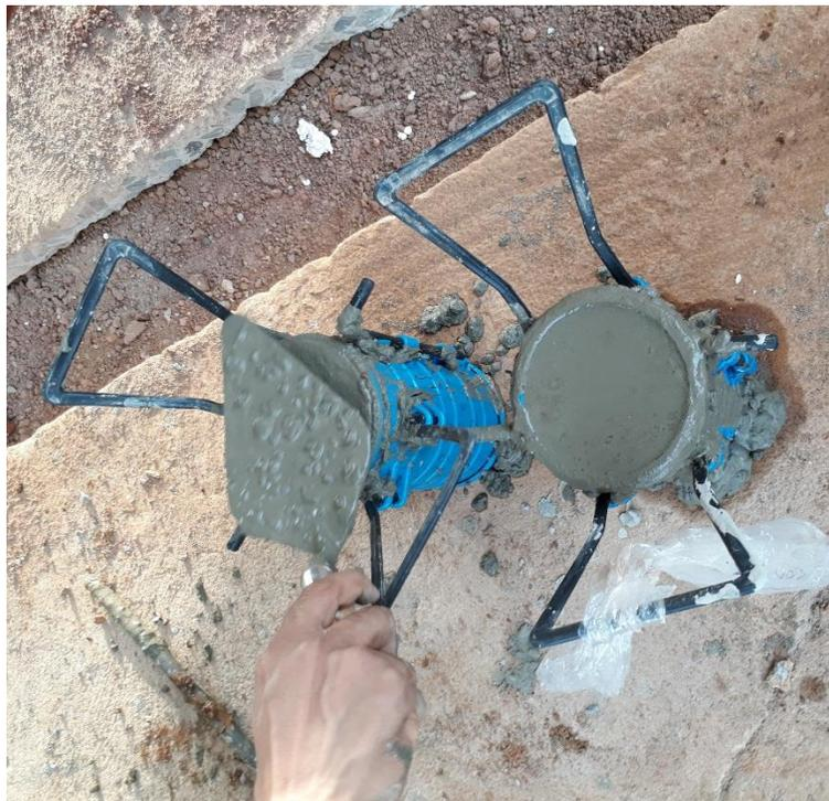
*Imagen 31. Toma de cilindros de la viga de cimentación de portería.
