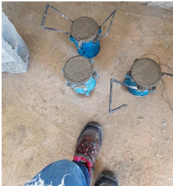
*Imagen 33. Toma de cilindros para dovelas.
