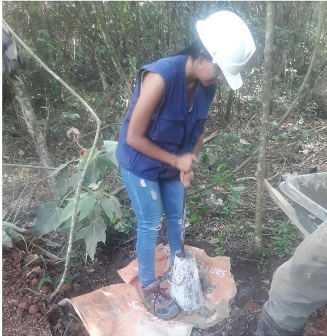
*Imagen 34. Prueba de slump para zapata 1 de viaducto Corpopaló.
