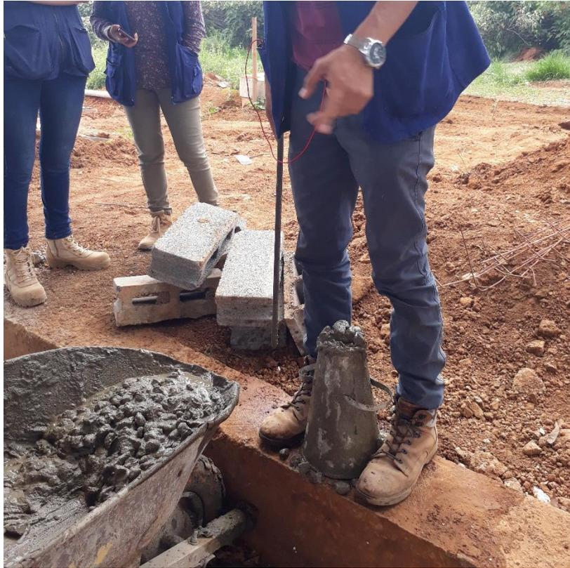
*Imagen 30. Prueba de slump para viga de cimentación de portería.
