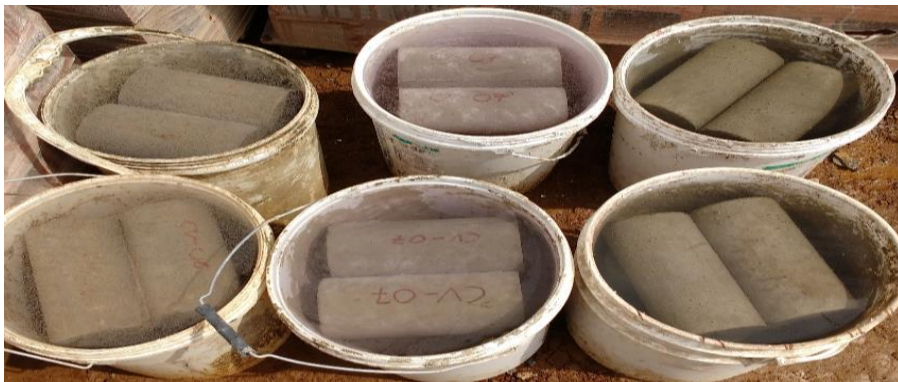
Imagen 37: Curado de cilindros.
