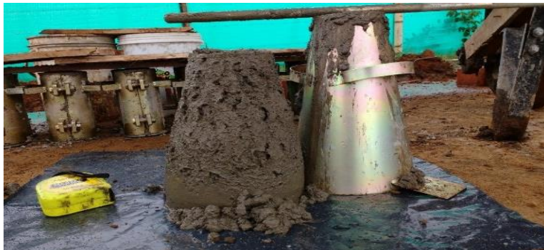
Imagen 36: Prueba de asentamiento "slump".
