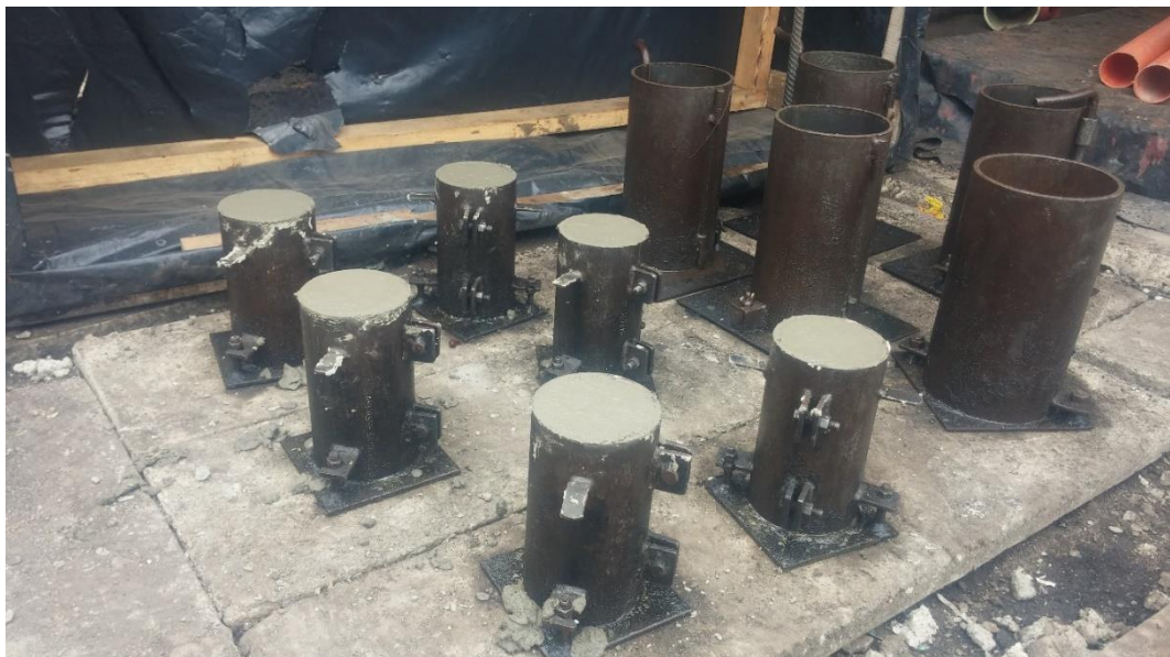
Figura No. 48. Especímenes de prueba para determinación de resistencia a la compresión
