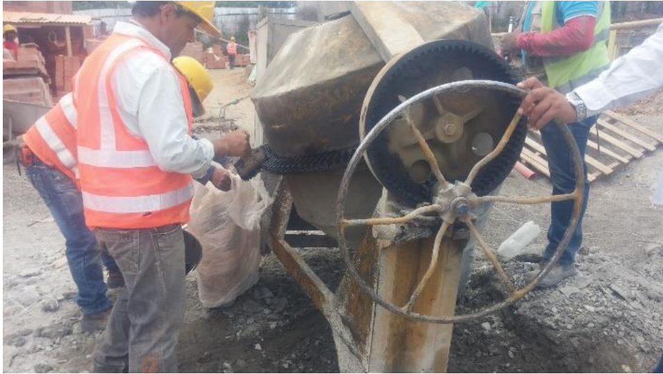
Figura No. 62. Mantenimiento a mezcladora mecánica
