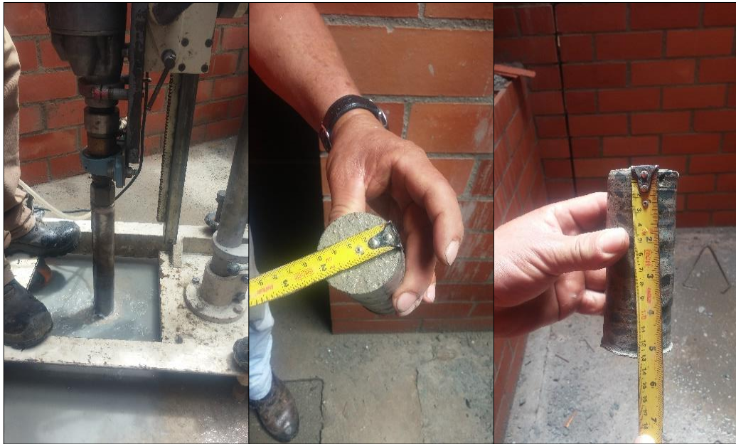
Figura No. 50. Proceso de extracción núcleo de concreto
