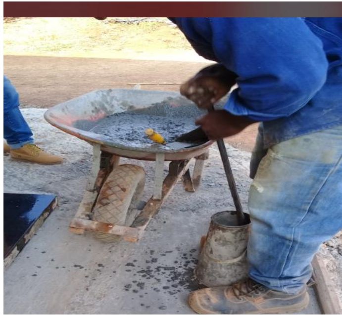
Ilustración 12. Ensayo asentamiento Fuente propia
