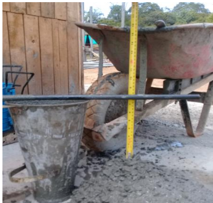
Fuente propia Ilustración 13. Medición asentamiento
