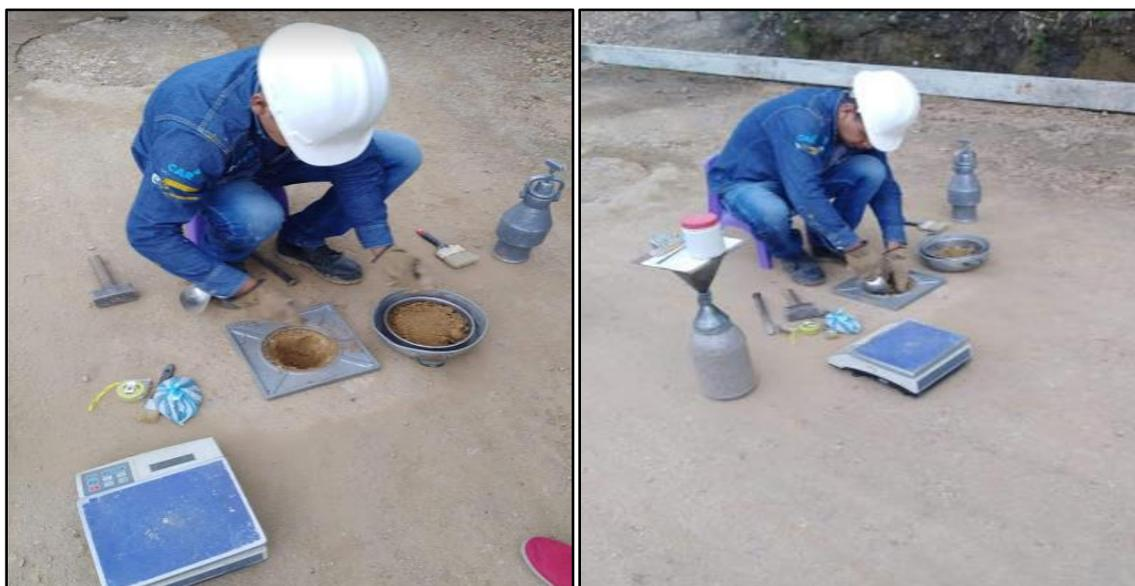
Figura 59. Toma de muestras para ensayos
