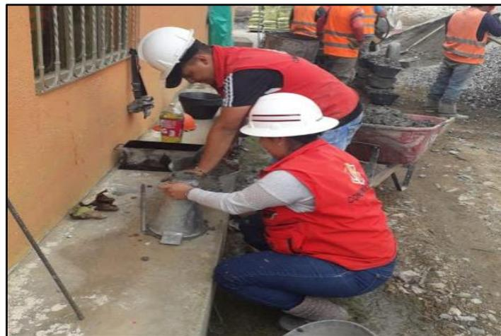
Figura 68. Toma de muestras para ensayos, ensayo de asentamiento con cono Slump
