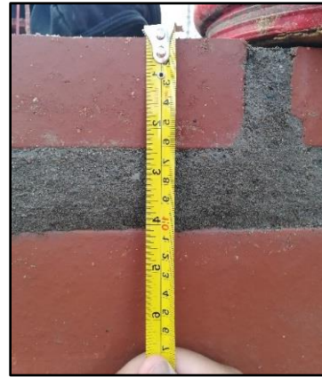
Fotografía 8: chequeo de espesor de mortero
