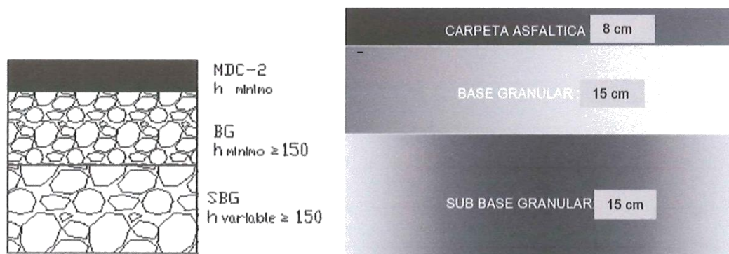
Figura 9.4.10: Estructura De Pavimento – Santafé
