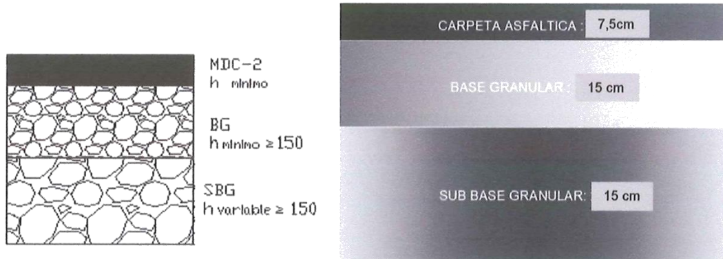
Figura 9.4.6: Estructura De Pavimento – B/ Comuneros
