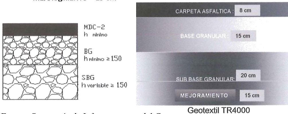
Figura 9.4.12: Estructura De Pavimento – Germania
