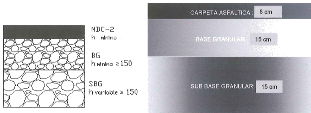
Figura 9.4.9: Estructura De Pavimento – Veraneras
