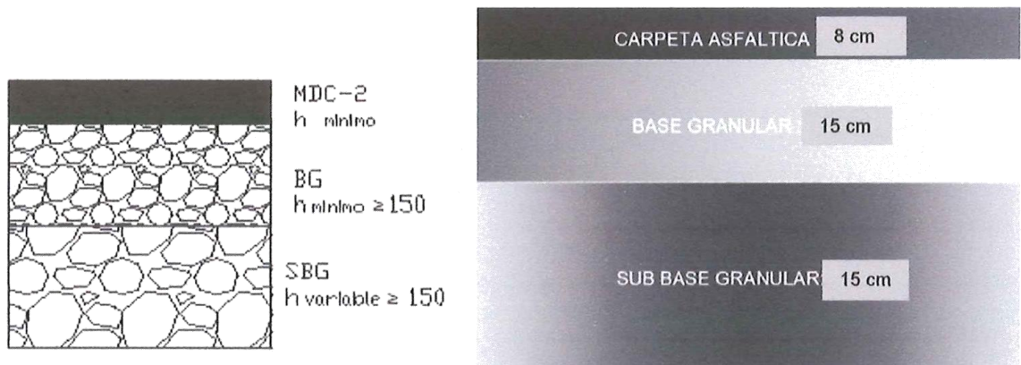
Figura 9.4.8: Estructura De Pavimento – Nuevo Japón
