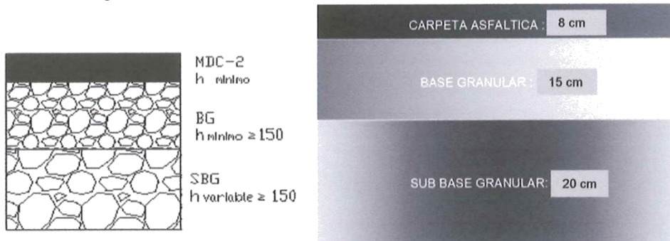
Figura 9.4.11: Estructura De Pavimento – Germania
