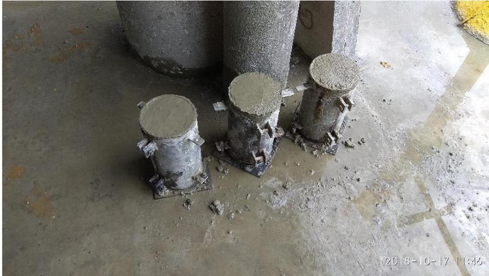
*Figura N° 35. Toma de muestras para ensayo de resistencia. Fuente Propia.*
