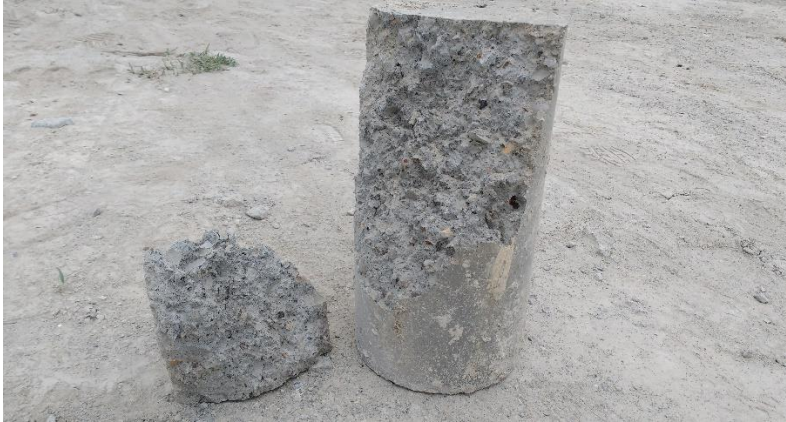
Figura 24 Cilindro con agregado no convencional cáscara de macadamia
