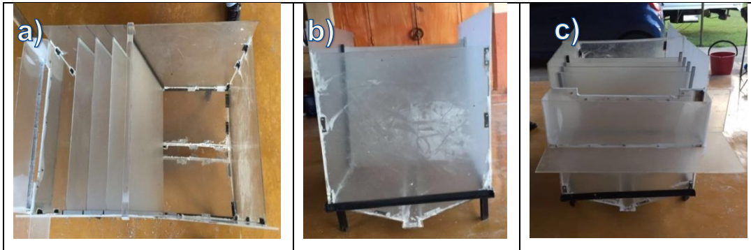
Figura 17. Proceso de construcción de sedimentador de placas paralelas.
