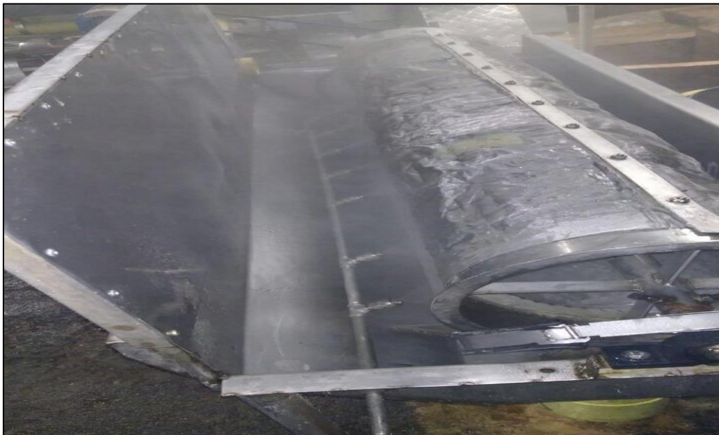
Figura 13. Maquina Extractora de Almidón en funcionamiento, con boquillas de alta presión y membrana de separación.
