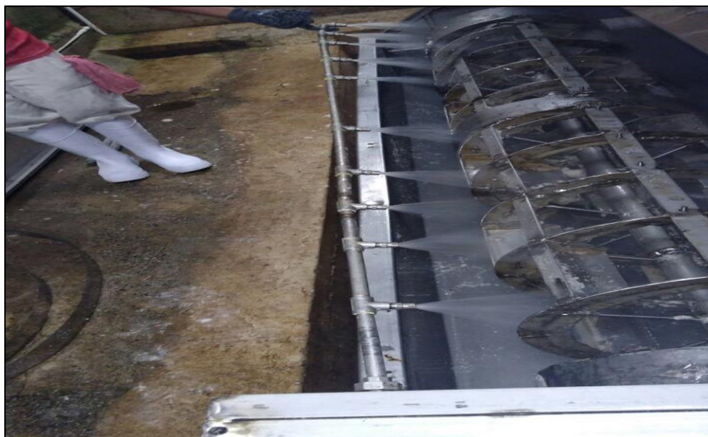
Figura 12. Montaje de boquillas de alta presión en la maquina extractora de almidón.
