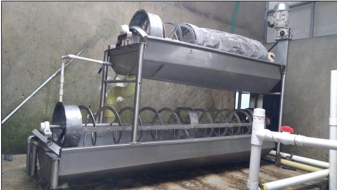
Figura 10. Montaje de la maquina extractora de almidón actual.
